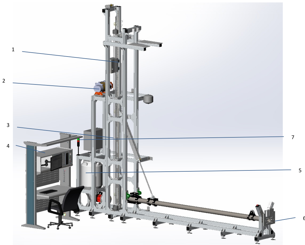
Рис. 3. Общий вид установки КМС-УПУ вертикального исполнения для поверки и калибровки уровнемеров.
