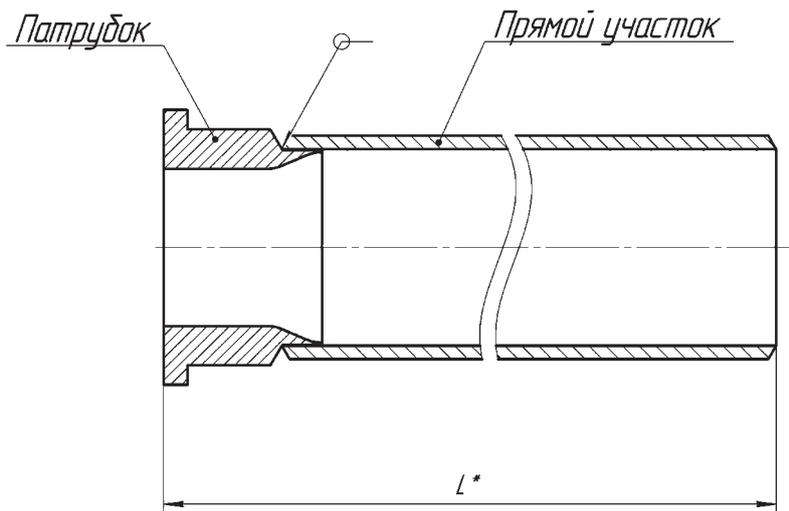
Рис.12. Для Ду150, 200 мм прямой участок приваривается к патрубку, накладной фланец устанавливается на патрубок (фланец условно не показан)
