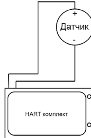
Рис. 3. Схема подключения с использованием встроенного источника питания. Для использования данного варианта необходимо подключить перемычки 1 и 2 на HART-модеме
