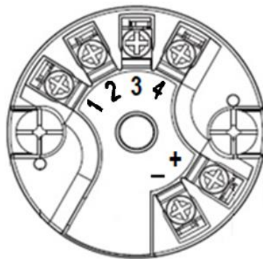
Рисунок Л.2 – Размещение клемм ИП Метран-2700
