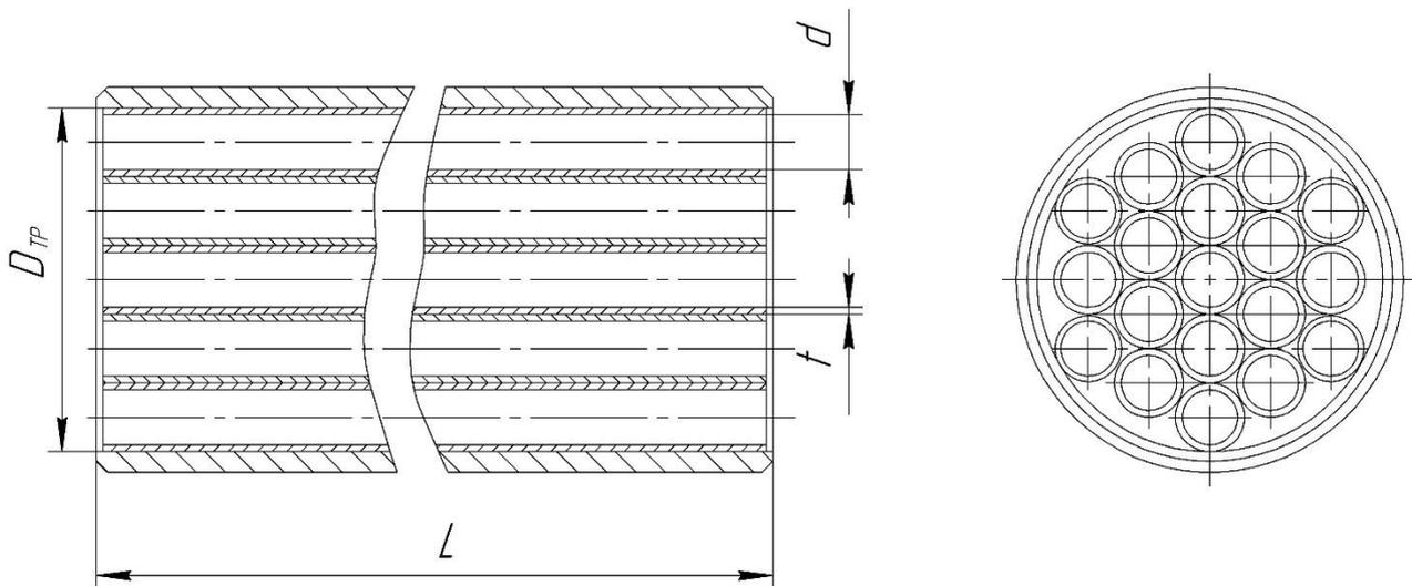
Рисунок И.1 – Конструкция струевыпрямителя
