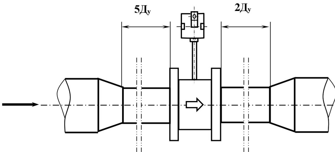
Рисунок Ж. 2 – Монтаж преобразователя на трубопроводе большего диаметра
