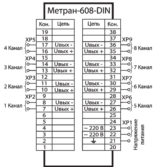
Рис.7. Схема подключения блоков Метран-608 (исполнение DIN).
