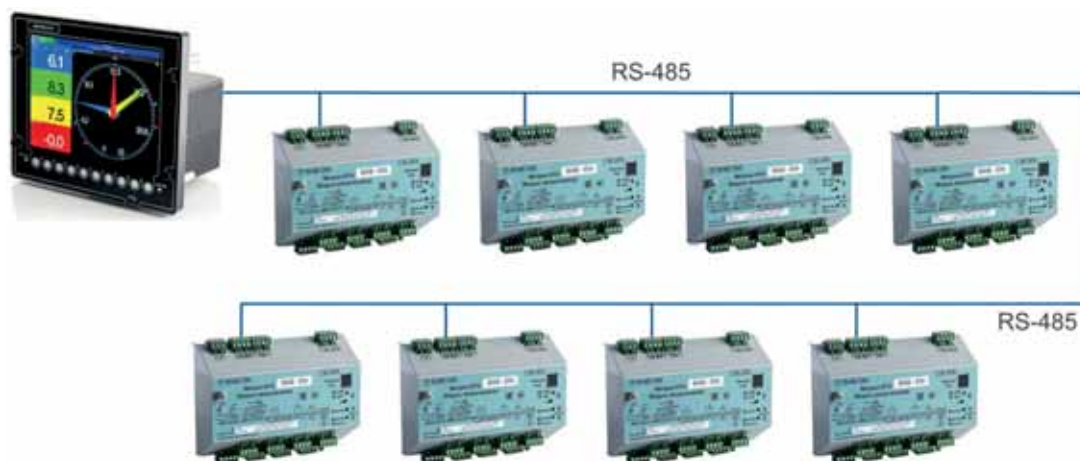
Рис. 24. Распределённая система сбора данных на базе Метран-910 и Метран-970.
