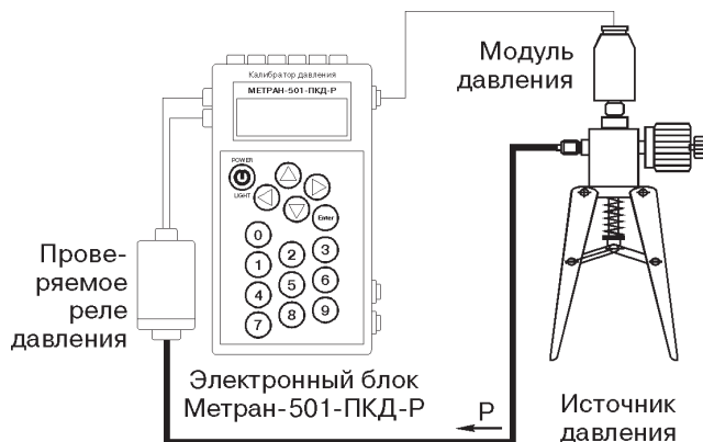
Рис.3. Проверка реле давления.
