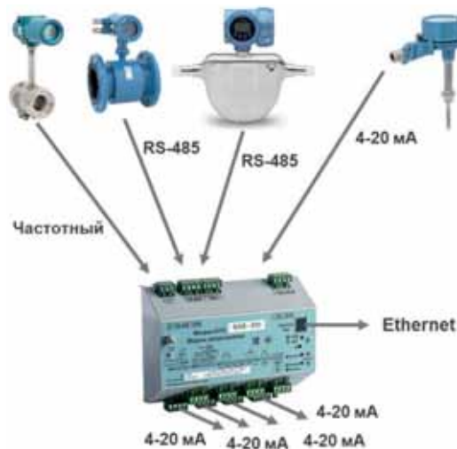
Рис. 14. Преобразование сигналов полевых устройств в токовый 4-20 мА
