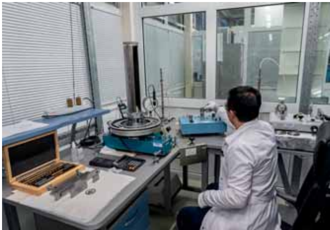
Ремонт и градуировка пневматических калибраторов давления Метран-500 Воздух
