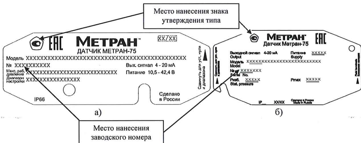
Рисунок 2 – Общий вид (схема) маркировочной таблички для датчиков: а) моделей 75А, 75G; б) моделей 75РА, 75ТА, 75ТG, 75РG, 75СG, 75СD и место нанесения знака утверждения типа и заводского номера
