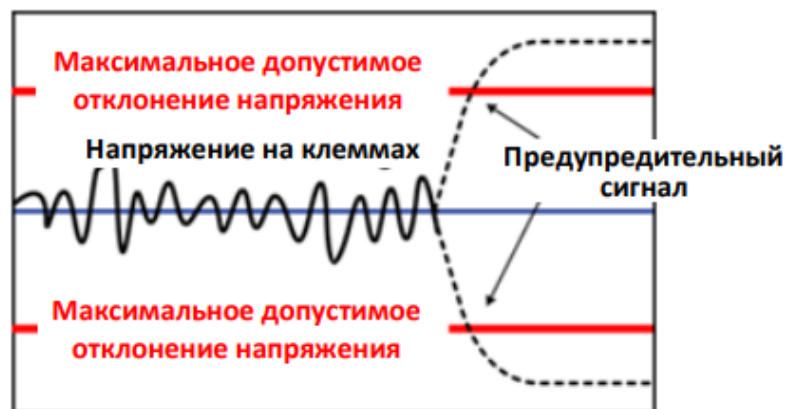
Рисунок Н.2 – Максимальное допустимое отклонение напряжения
