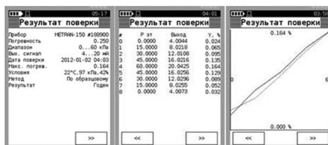
Для поверки и калибровки рекомендуется использование программного обеспечения "Поверка СИД", которое обеспечивает управление поверкой, протоколирование и ведение базы данных с результатами поверки (ПО входит в комплект поставки калибратора).
