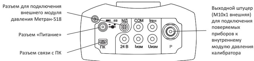
Рис. 1. Панель подключения (портативное исполнение)
