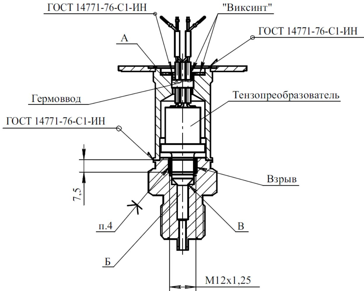
1. Шов А испытан на прочность давлением 1 МПа. Разрушение не допускается.
