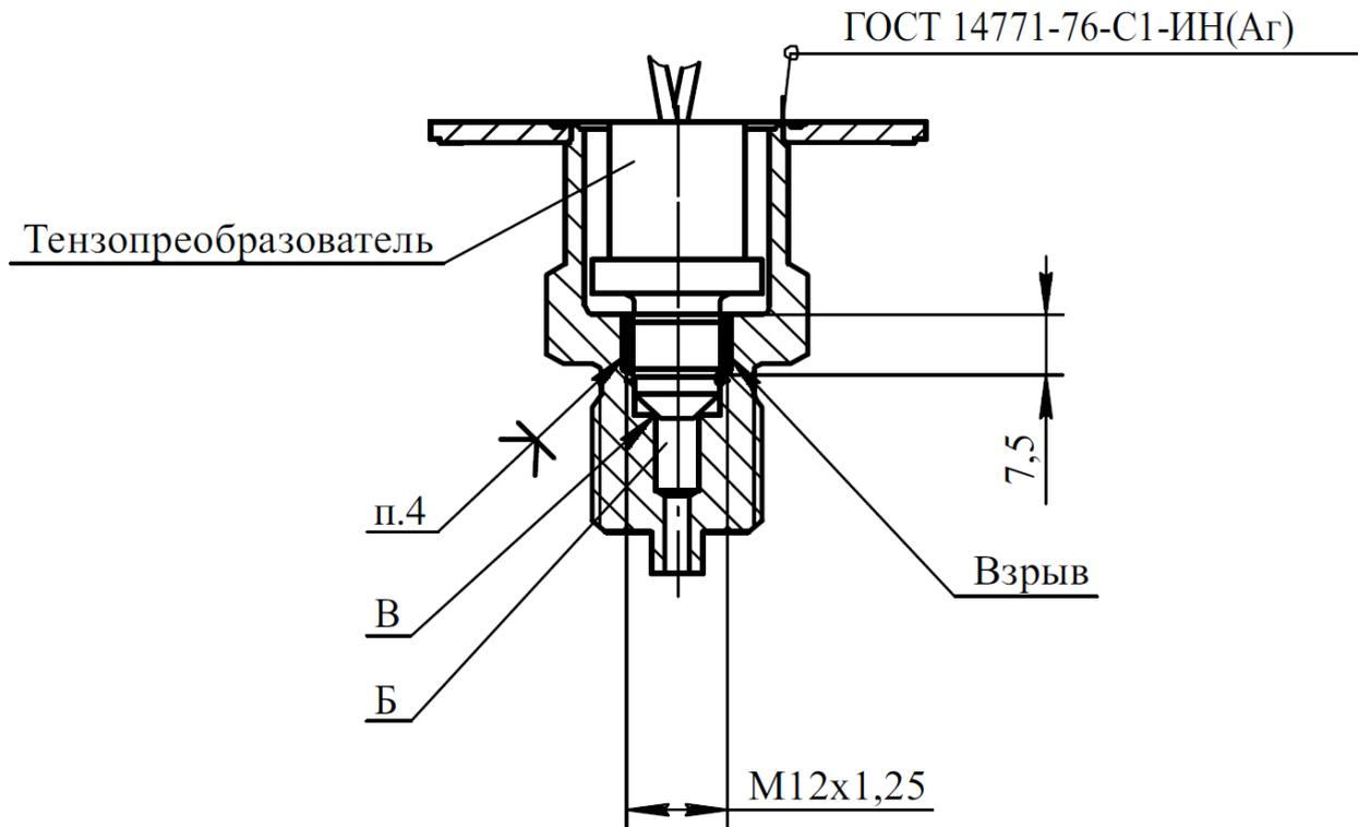
1. Шов испытан на прочность давлением 1 МПа. Разрушение не допускается.
