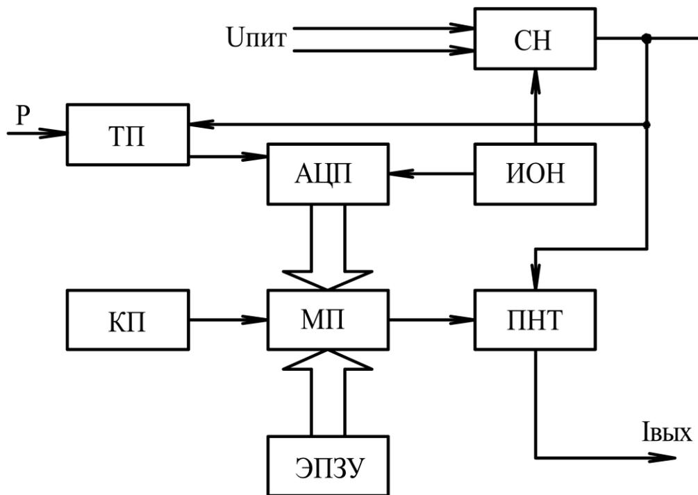
Рисунок 3 – Функциональная схема электронного преобразователя
