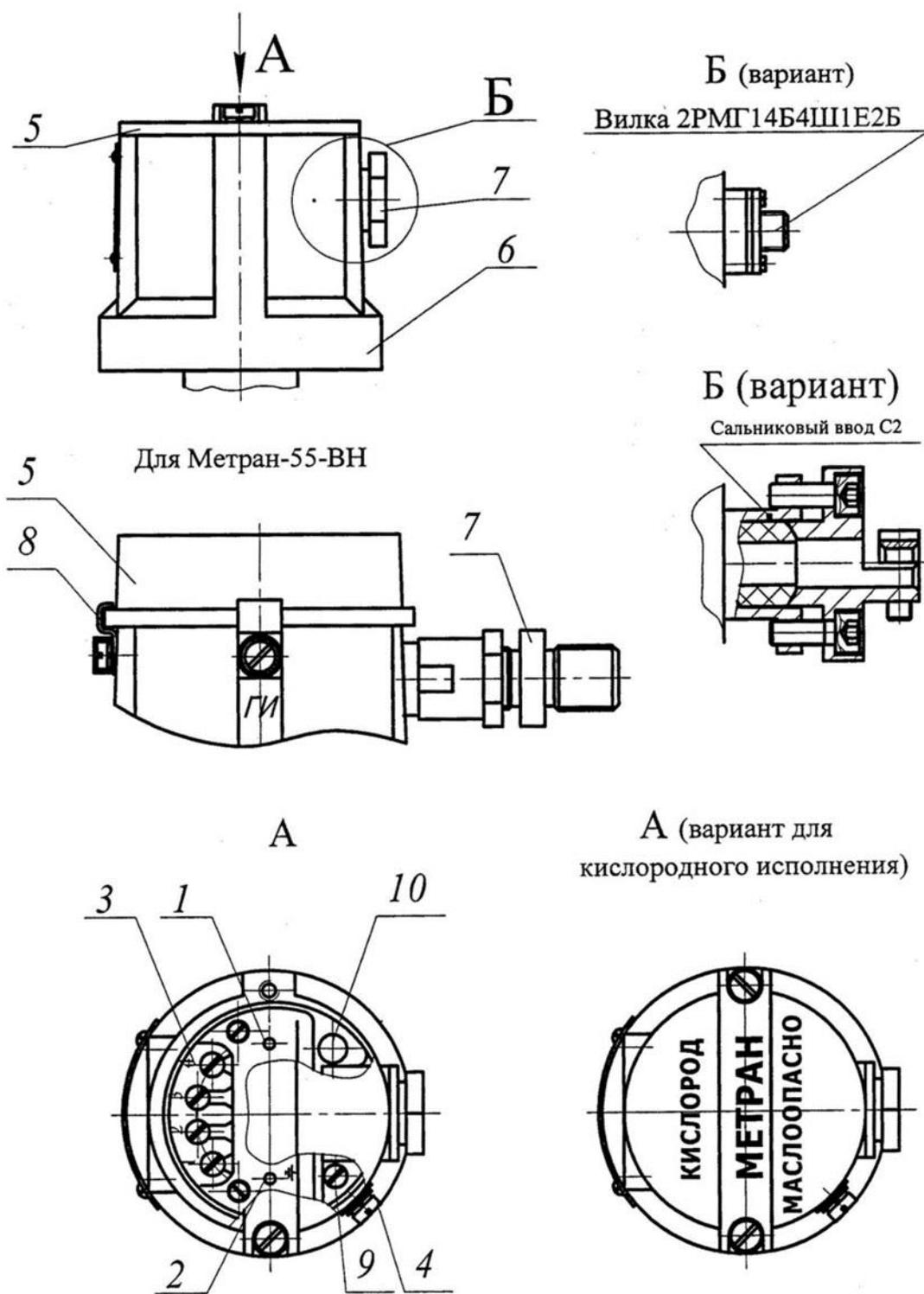
Рисунок 2 – Электронный преобразователь
