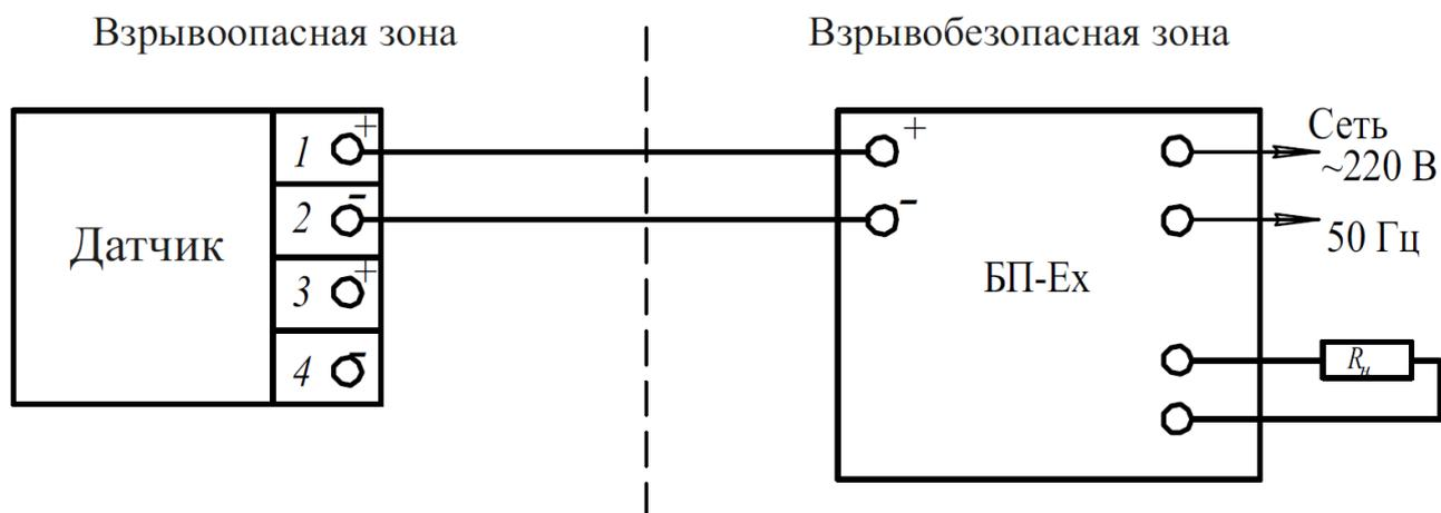
БП-Ех - искробезопасный блок питания
