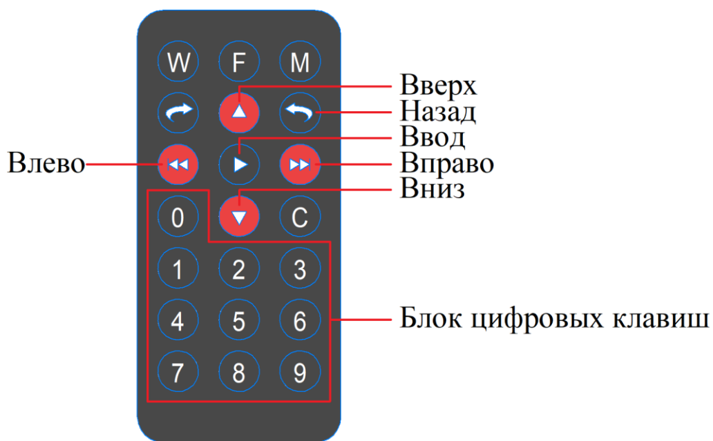
Рисунок 2.32 – Внешний пульт дистанционного управления
