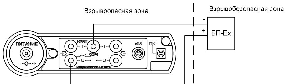
Рисунок Г.4 – Схема электрических подключений блока электронного калибратора к датчикам давления с выходным сигналом (0—5) мА, (5—0) мА, (0—20) мА, (20—0) мА (четырёхпроводная линия связи) во взрывоопасной зоне
