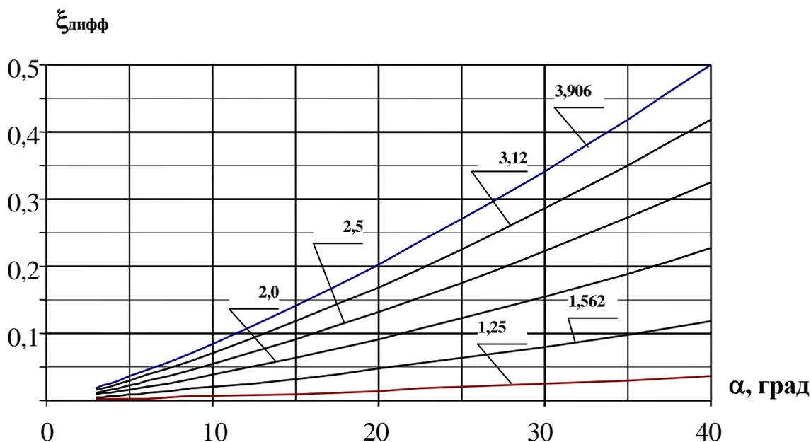
Рисунок Д.7 – Зависимость  $\xi_{\text{расш}}$  от угла  $\alpha$
