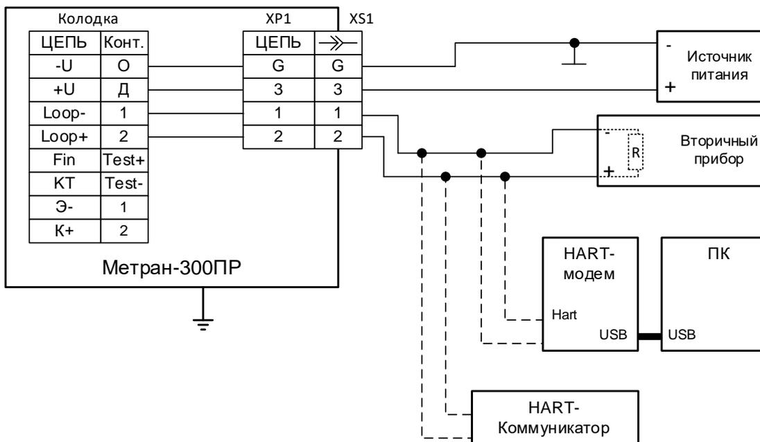
б) Токовый выходной сигнал
