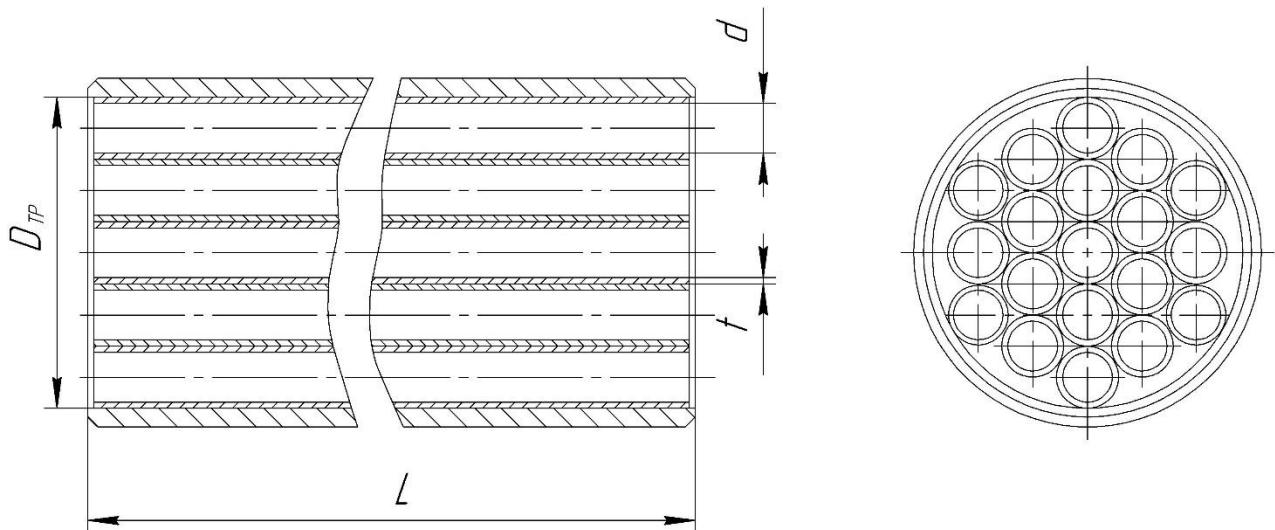
Рисунок И.1 – Конструкция струевыпрямителя
