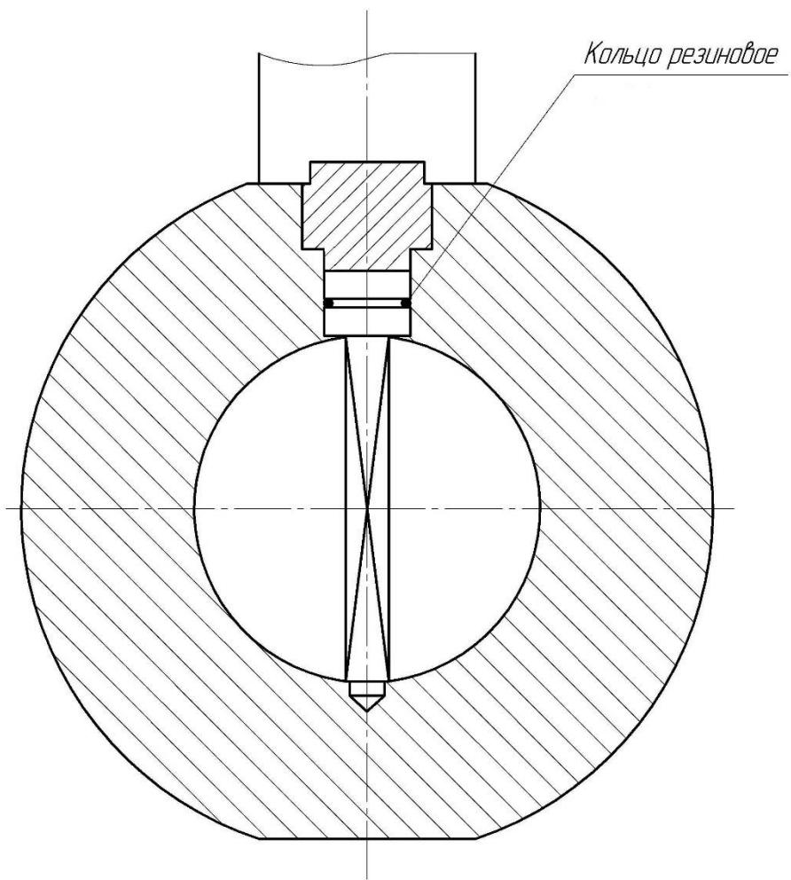
Рисунок Н.3 - Схема установки тела обтекания в проточной части преобразователей исполнения L типоразмеров Ду 32
