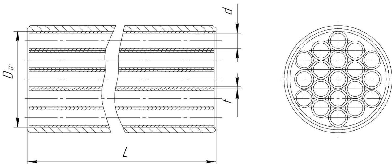
Рисунок И.1 – Конструкция струевыпрямителя
