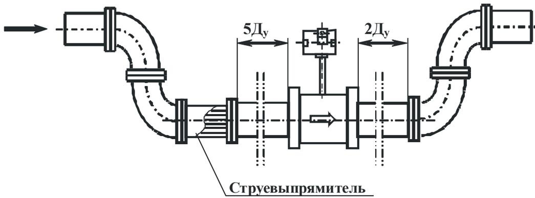
Рисунок Ж.5 - Установка преобразователя с двумя отводами  $90^\circ$  в одной плоскости
