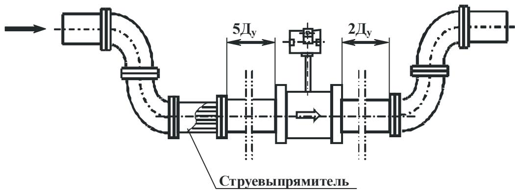
Рисунок Ж.5 - Установка преобразователя с двумя отводами  $90^\circ$
