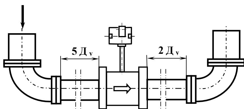
Рисунок Ж.4 - Установка преобразователя с отводами 90 °
