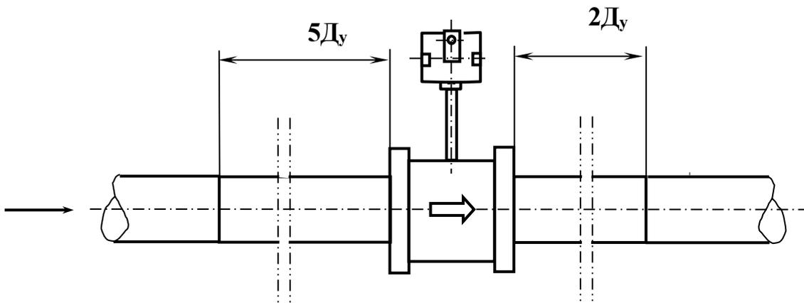
Примечание – Допускается монтаж преобразователя на вертикальном, горизонтальном или наклонном трубопроводе, при этом должно быть соблюдено условие полного заполнения жидкостью всего объема прямолинейных участков трубопровода и проточной части.
