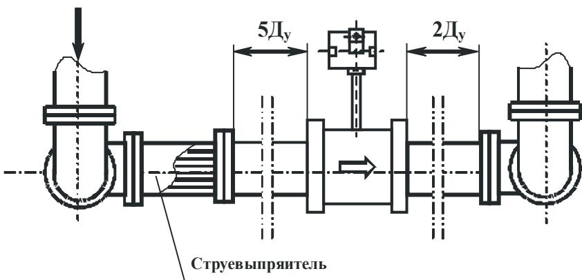
Рисунок Ж.6 - Установка преобразователя с двумя отводами  $90^\circ$
