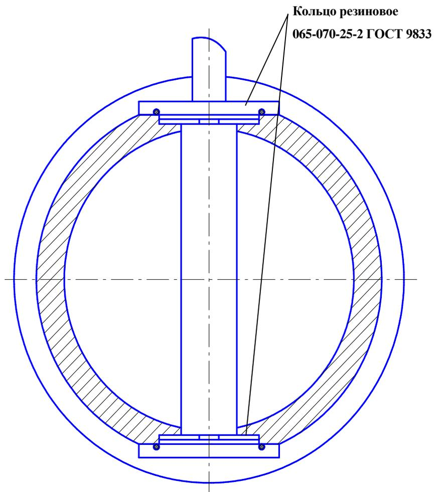
Рисунок Н.5 - Схема установки тела обтекания в проточной части преобразователей типоразмеров Ду 250, Ду 300 мм
