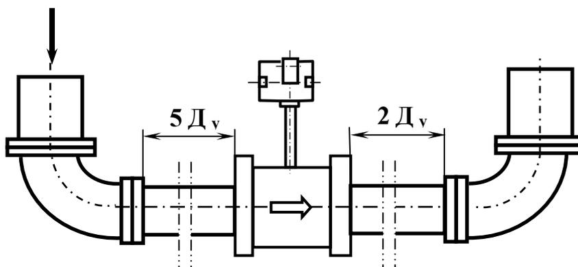
Рисунок Ж.4 - Установка преобразователя с отводами 90 °
