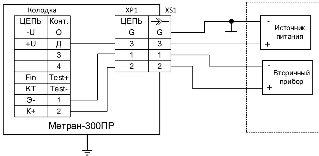
а) Выходной сигнал «открытый коллектор» (оптопара)
