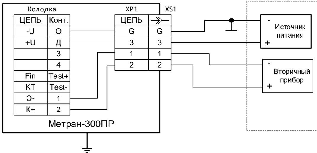
а) Выходной сигнал «открытый коллектор» (оптопара)
