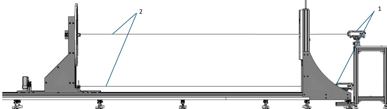
**Рис.2. Схема настройка установки для поверки и калибровки уровнемеров с применением лазерных интерферометров**
