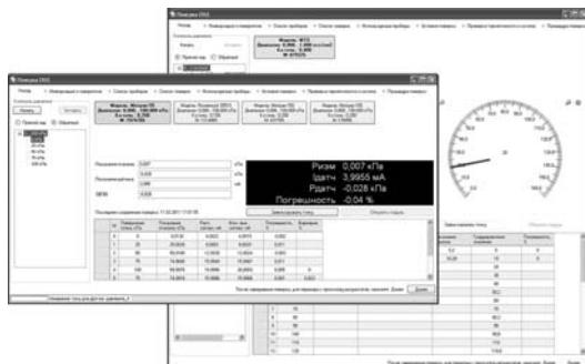
**Рис.5. Определение метрологических характеристик датчиков давления и манометров.**
