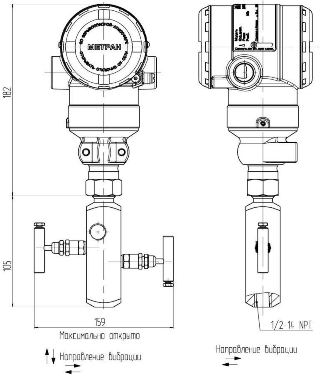
Рисунок Е.16 – Датчики моделей 150TGR, TAR с установленным клапанным блоком 0106. Остальное см. рисунок Е.1
