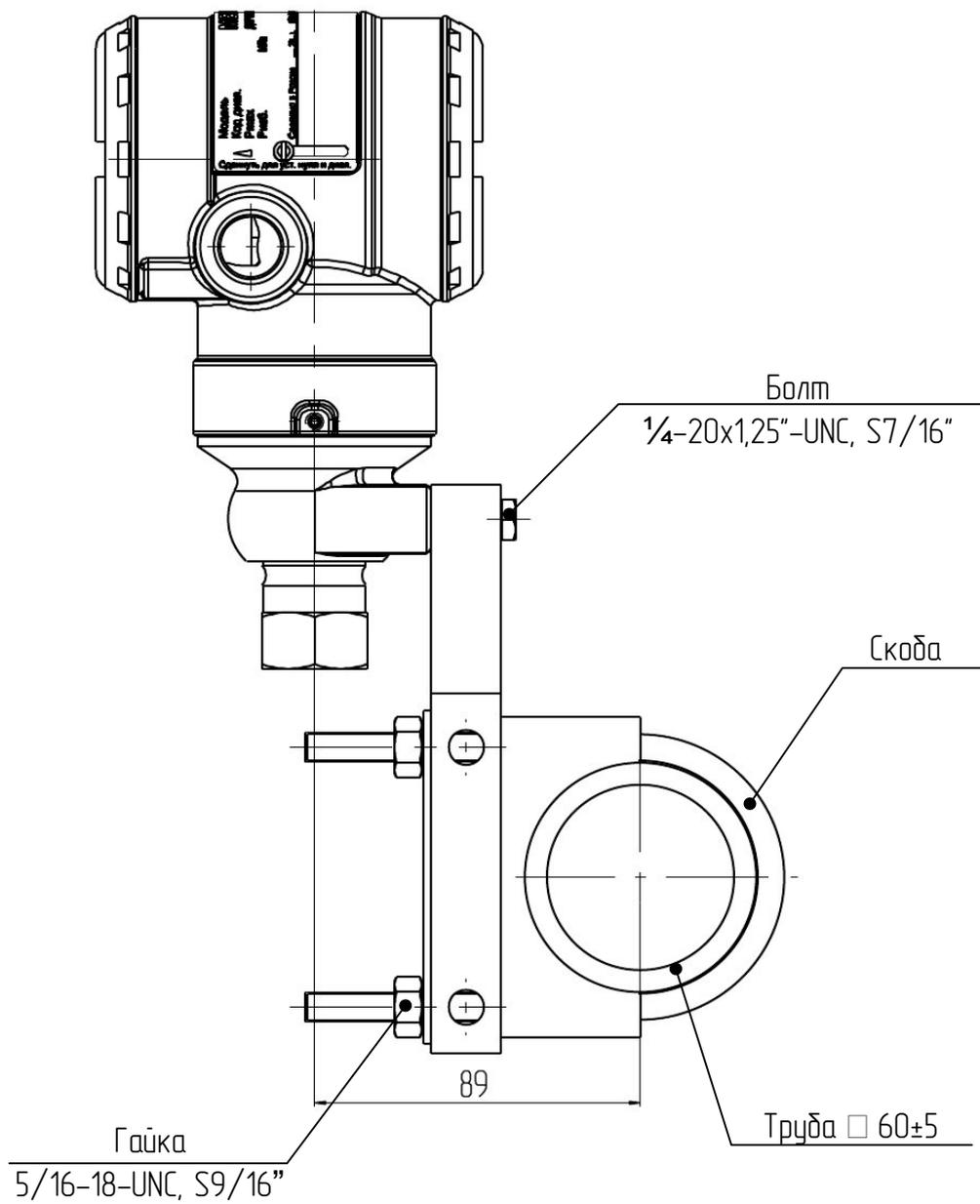
Рисунок Е.18 – Датчики моделей 150TGR, TAR с установленным монтажным кронштейном для монтажа на трубе (код В4). Остальное см. рисунок Е.1.
