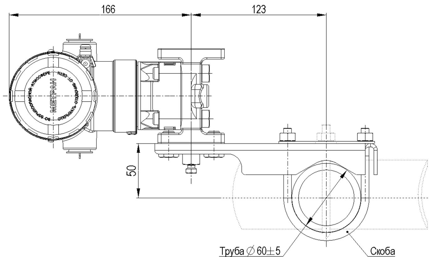
Рисунок Е.11а – Датчики моделей 150CDR, 150CGR с установленным монтажным кронштейном (код В3). Остальное см. рисунок Е.1, Е.11
