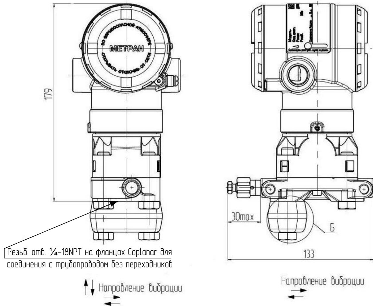
Рисунок Е.5 – Датчик модели 150CGR с фланцем сорлапаг и установленным фланцем 1/2NPT (код D4).
