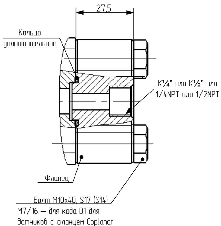
Рисунок Е.22 – Выносной элемент Б – монтажные части коды D1-D4
