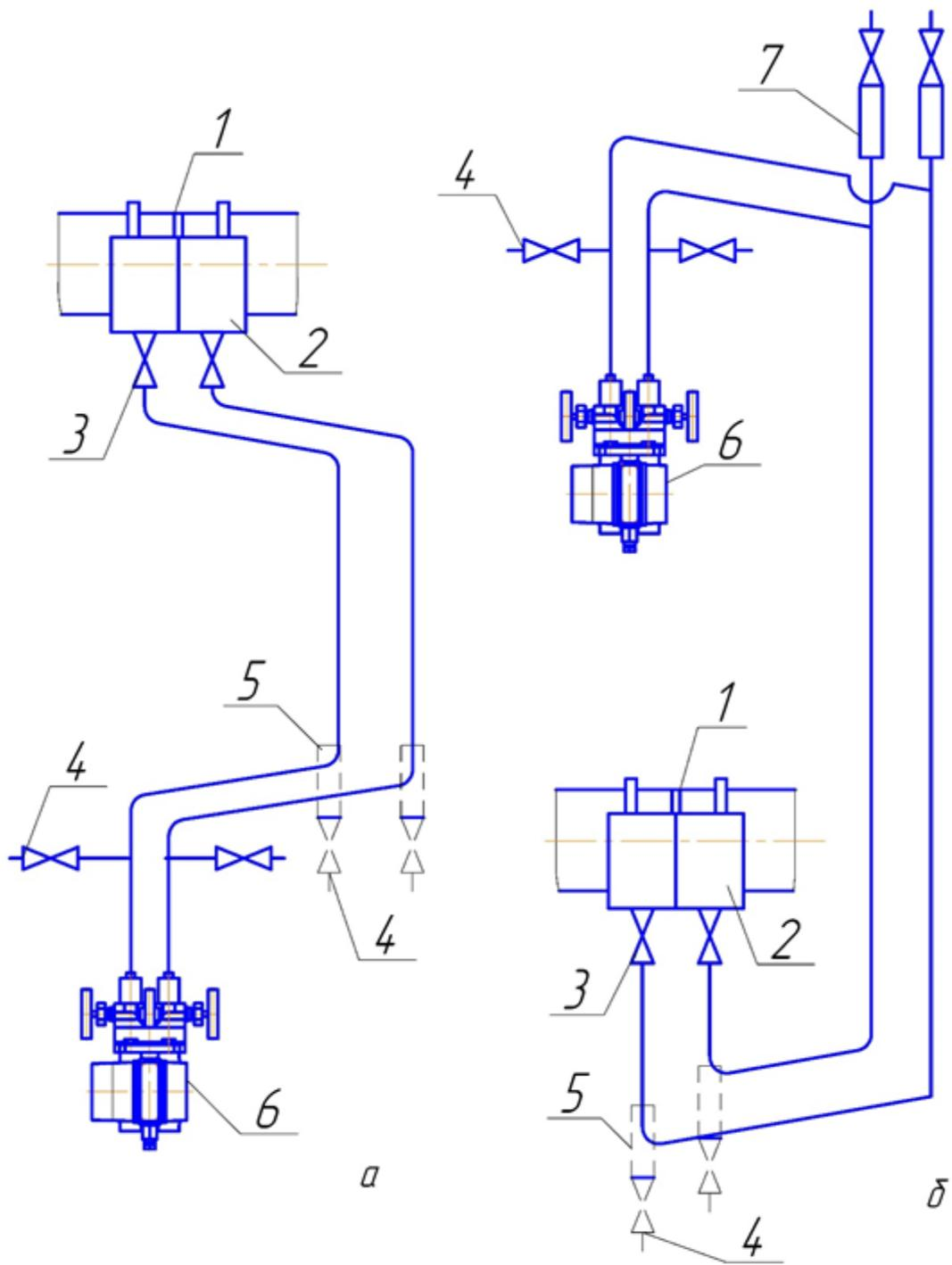
Рисунок 7 – Схемы соединительных линий при измерении расхода пара
