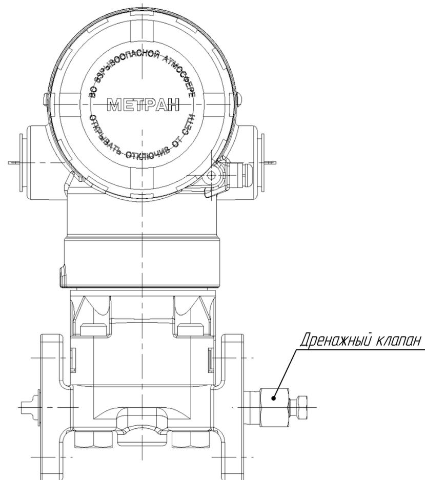
Рисунок Е.2 – Датчики моделей 150CDR, 150CGR с традиционным фланцем.
