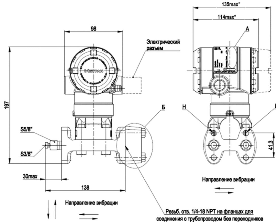
H и L – маркировка подвода давления на корпусе датчика: H соответствует большему давлению; L соответствует меньшему давлению
