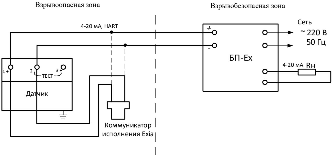
БП-Ех – искробезопасный блок питания (например, Метран-602-Ех)
