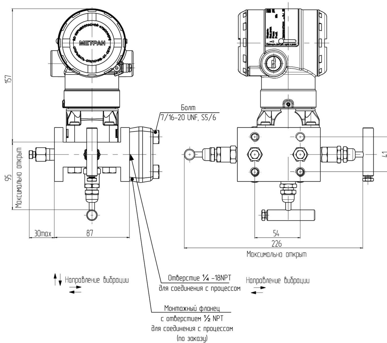
Рисунок Е.9 – Датчик модели 150CDR с установленным 3-х вентильным клапанным блоком 0105MT (код S5).
