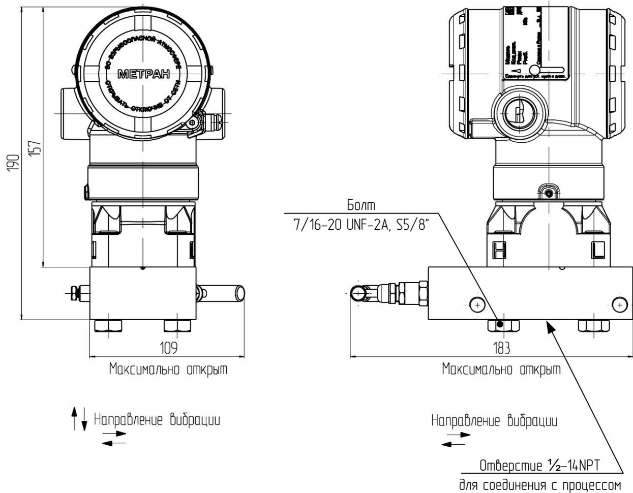
Рисунок Е.7 – Датчик модели 150CGR с установленным 2-х вентильным клапанным блоком 0105MC или 0105MS вариант подключения к процессу В или D (код S5). Остальное см. рисунок Е.1.
