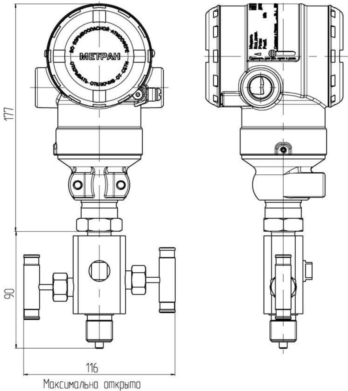
Рисунок Е.15 – Датчики моделей 150TGR, TAR с кодом 2G и установленным клапанным блоком 0106. Остальное см. рисунок Е.1.
