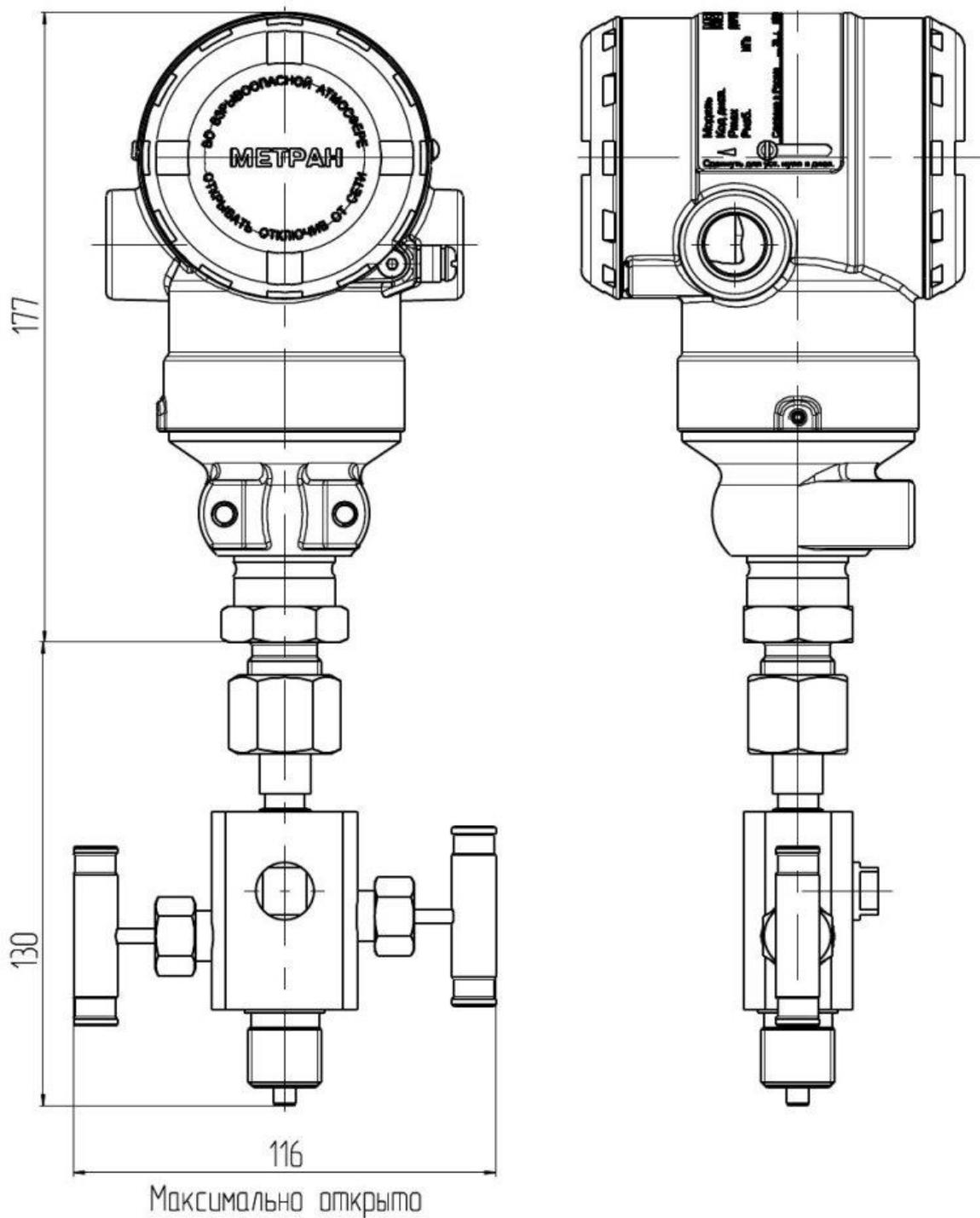
Рисунок Е.14 – Датчики моделей 150TGR, TAR с кодом 2G и установленным клапанным блоком 0106. Остальное см. рисунок Е.1.
