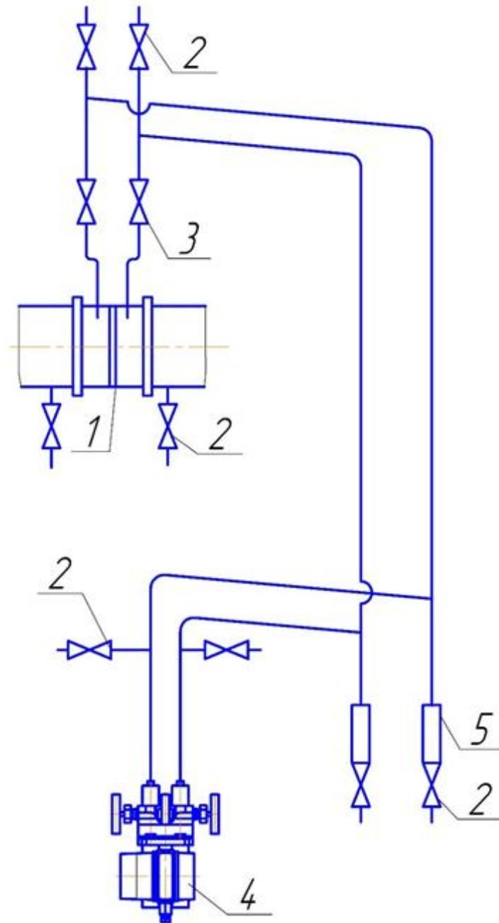
Рисунок 6 – Схема соединительных линий при измерении расхода газа
