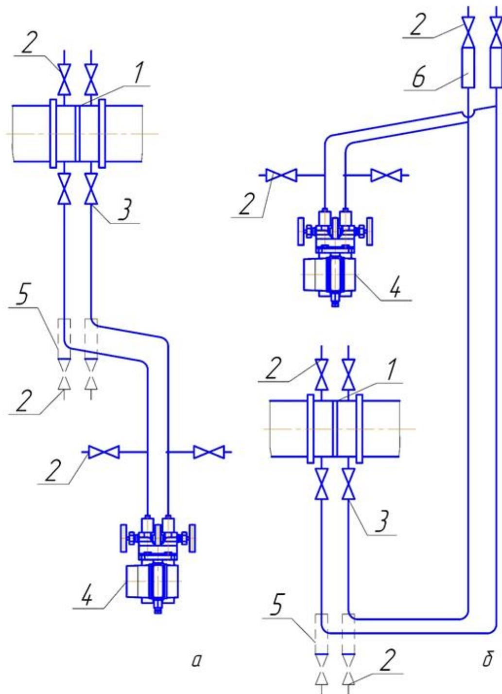
Рисунок 8 – Схемы соединительных линий для измерения расхода жидкости
