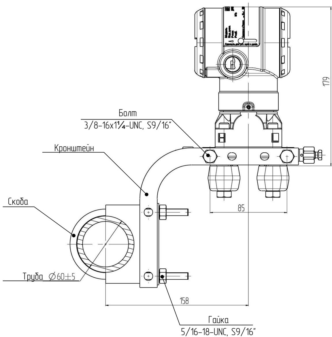
Рисунок Е.10 – Датчики моделей 150CDR, 150CGR с установленным монтажным кронштейном (код В4). Остальное см. рисунок Е.1.
