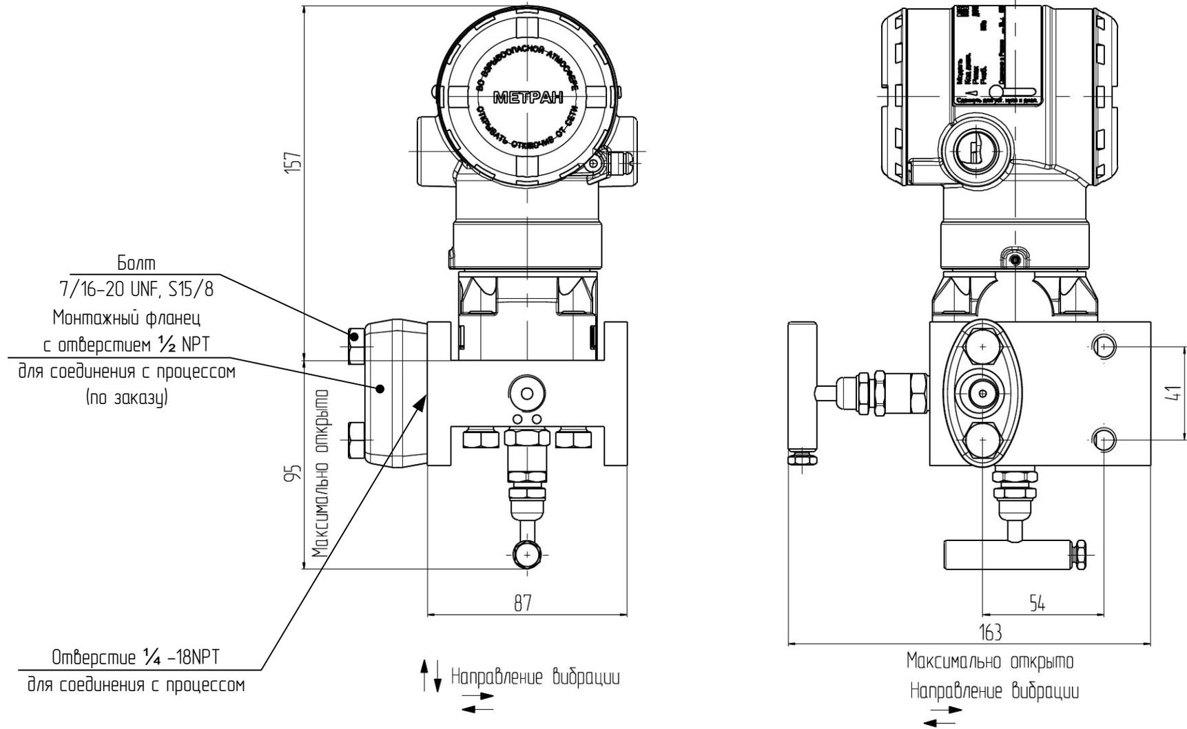
Рисунок Е.8 – Датчик модели 150CGR с установленным 2-х вентильным клапанным блоком 0105MT (код S5).
