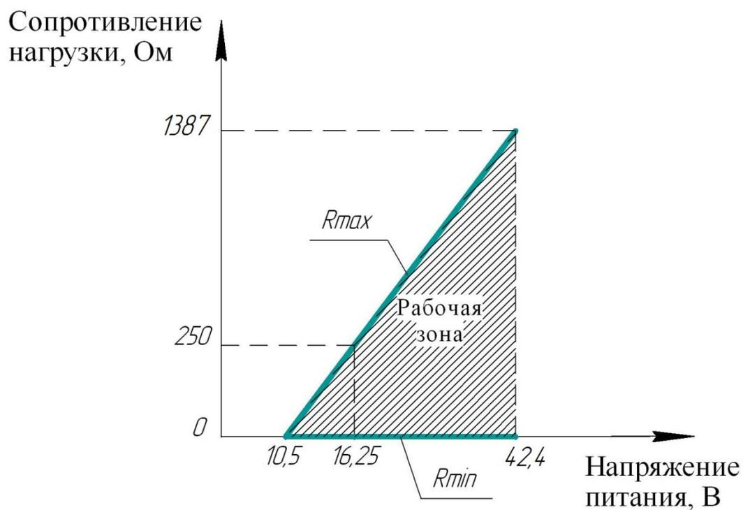
$R_{min}=250$  Ом – для датчиков с HART-сигналом
