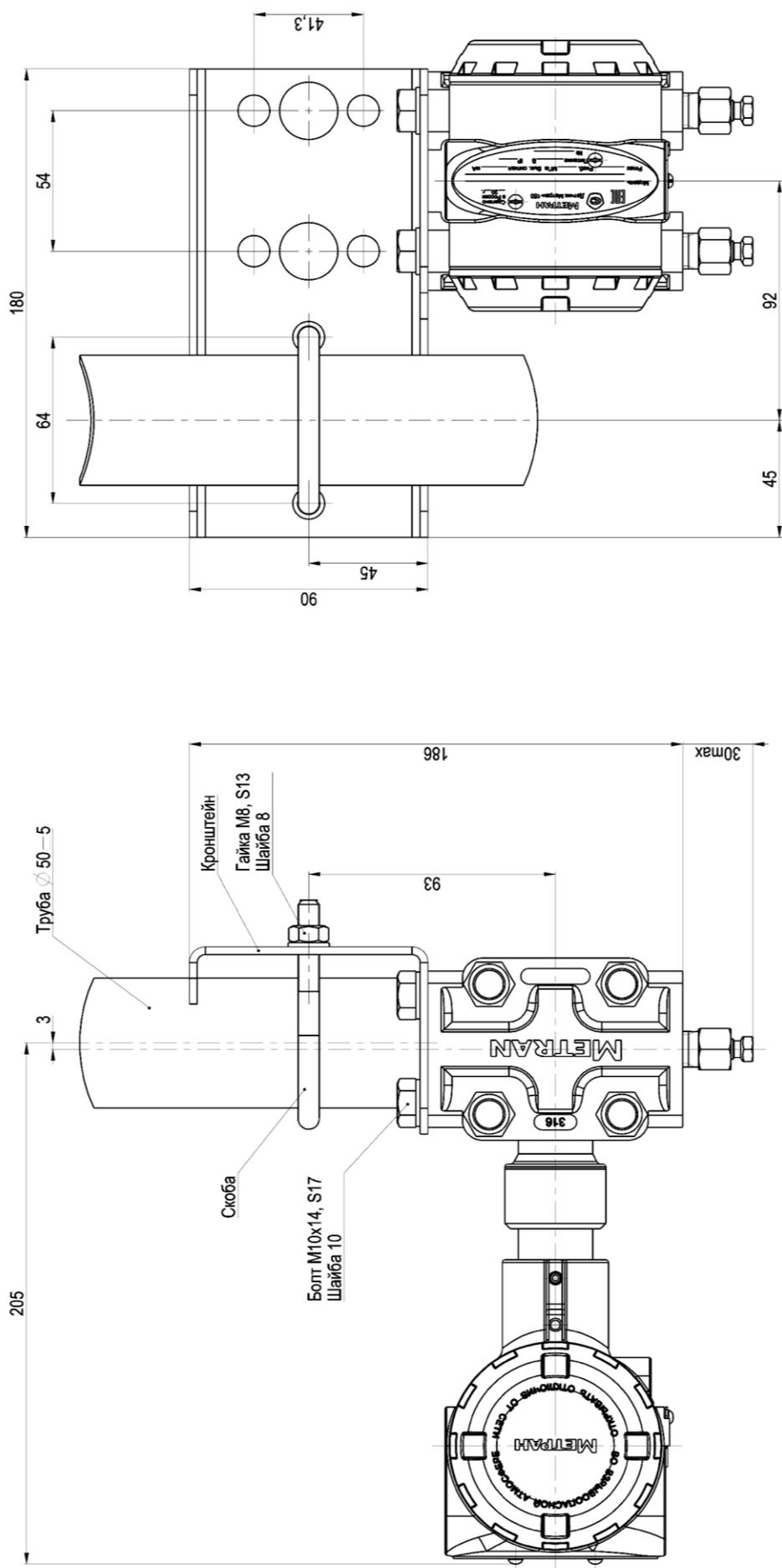
Рисунок Ж.4 – Датчики моделей 150CD, 150CG с кодами диапазонов 1Г–6Г с монтажным кронштейном для установки на трубе или панели (код В1 или В4), труба показана вертикально
