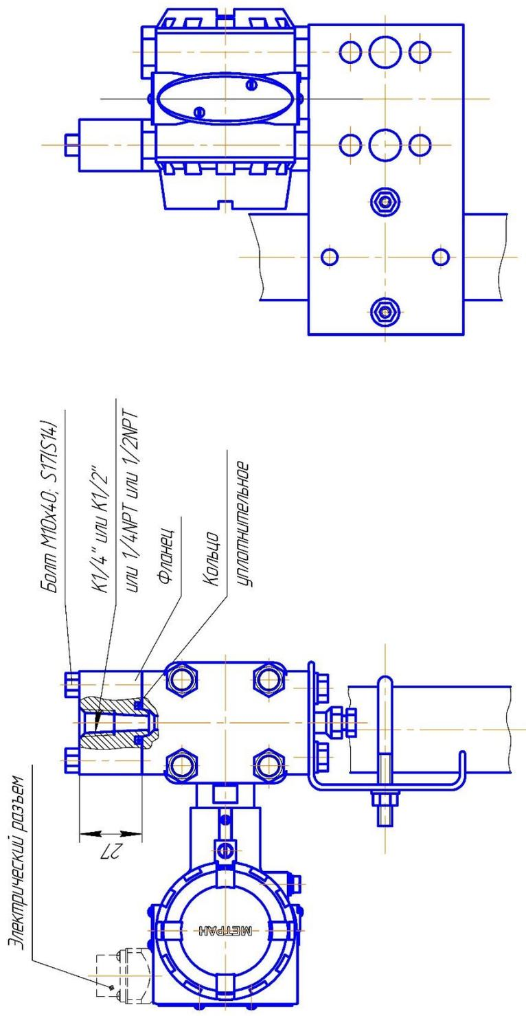
Рисунок Ж.19 – Датчики модели 150CG с кодами диапазонов 0–5 с установленным монтажным фланцем с резьбовым отверстием K1/4" (код D1), или K1/2" (код D2), или 1/4 NPT (код D3) или 1/2 NPT (код D4) и монтажным кронштейном для установки на двухдюймовой трубе (код В1 или В4). Остальное см. рисунок Ж.16
