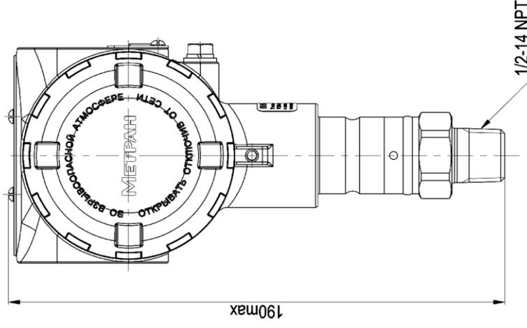
Рисунок Ж.8 – Датчики моделей 150TG, 150TA (коды диапазонов 0Г–5Г) с кодами соединения с процессом 2В, 2N
