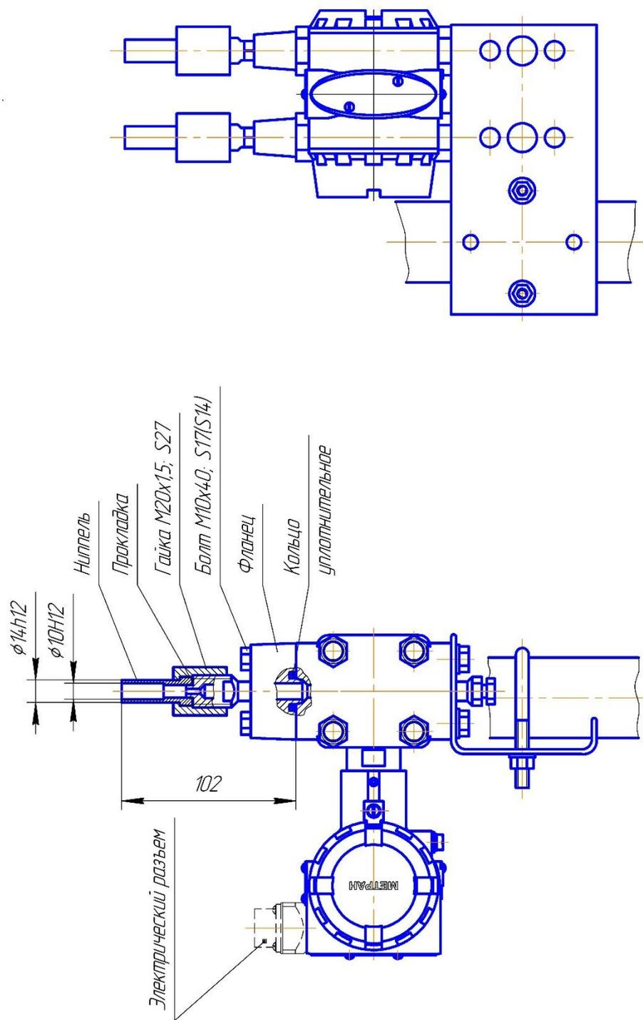
Рисунок Ж.13 – Датчики модели 150CD с кодами диапазонов 0–5 с установленными ниппелями под накидные гайки M20x1,5 (код D5) и монтажным кронштейном для установки на двухдюймовой трубе (код B1 или B4).
