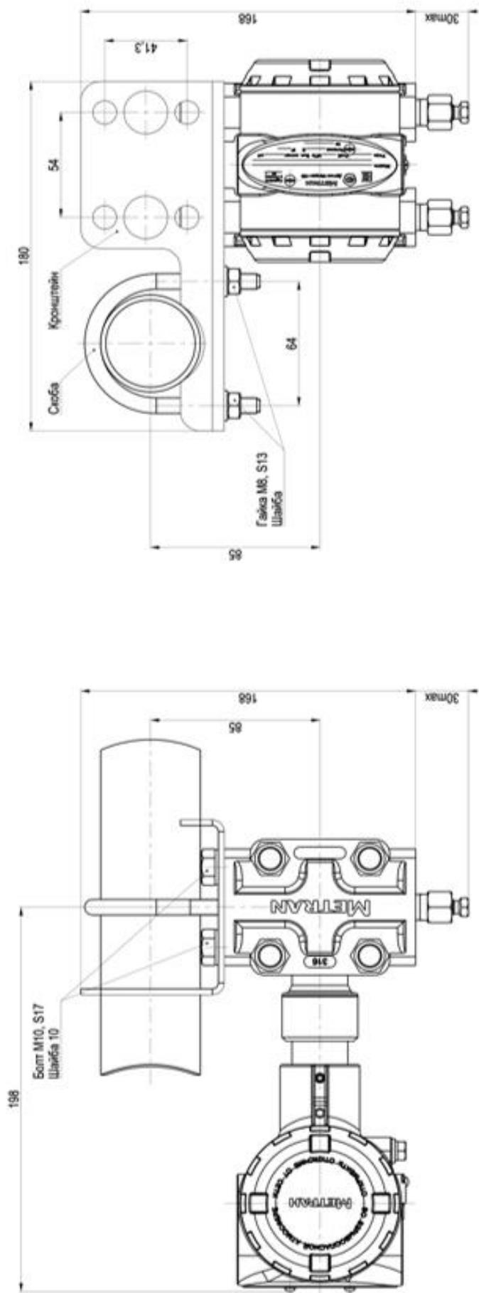
Рисунок Ж.5 – Датчики моделей 150CD, 150CG с кодами диапазонов 1Г–6Г с монтажным кронштейном для установки на трубе или панели (код В1 или В4), труба показана горизонтально
