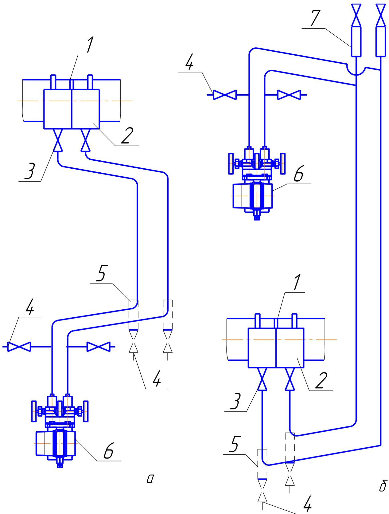
Рисунок 8-Схема соединительных линий при измерении расхода пара
