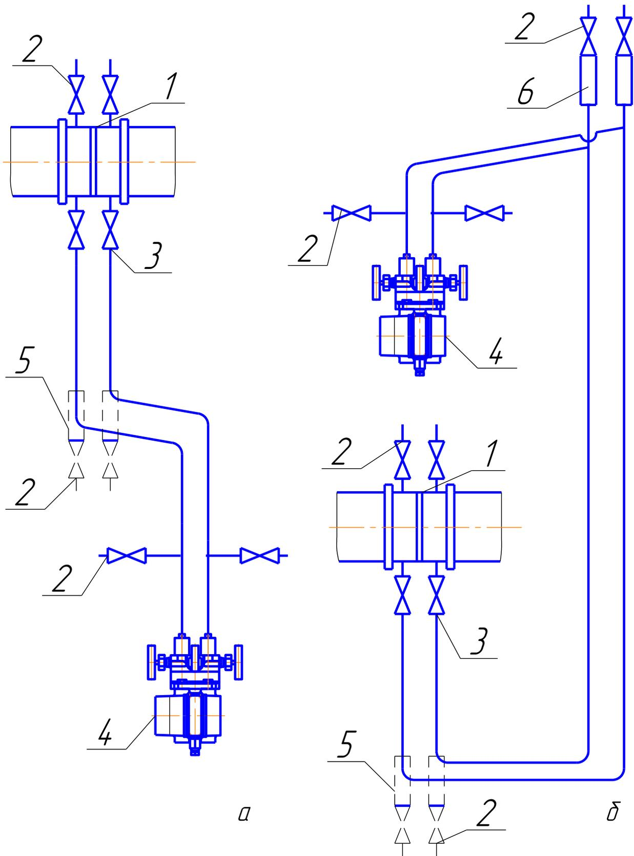
Рисунок 9-Схема соединительных линий при измерении расхода жидкости
