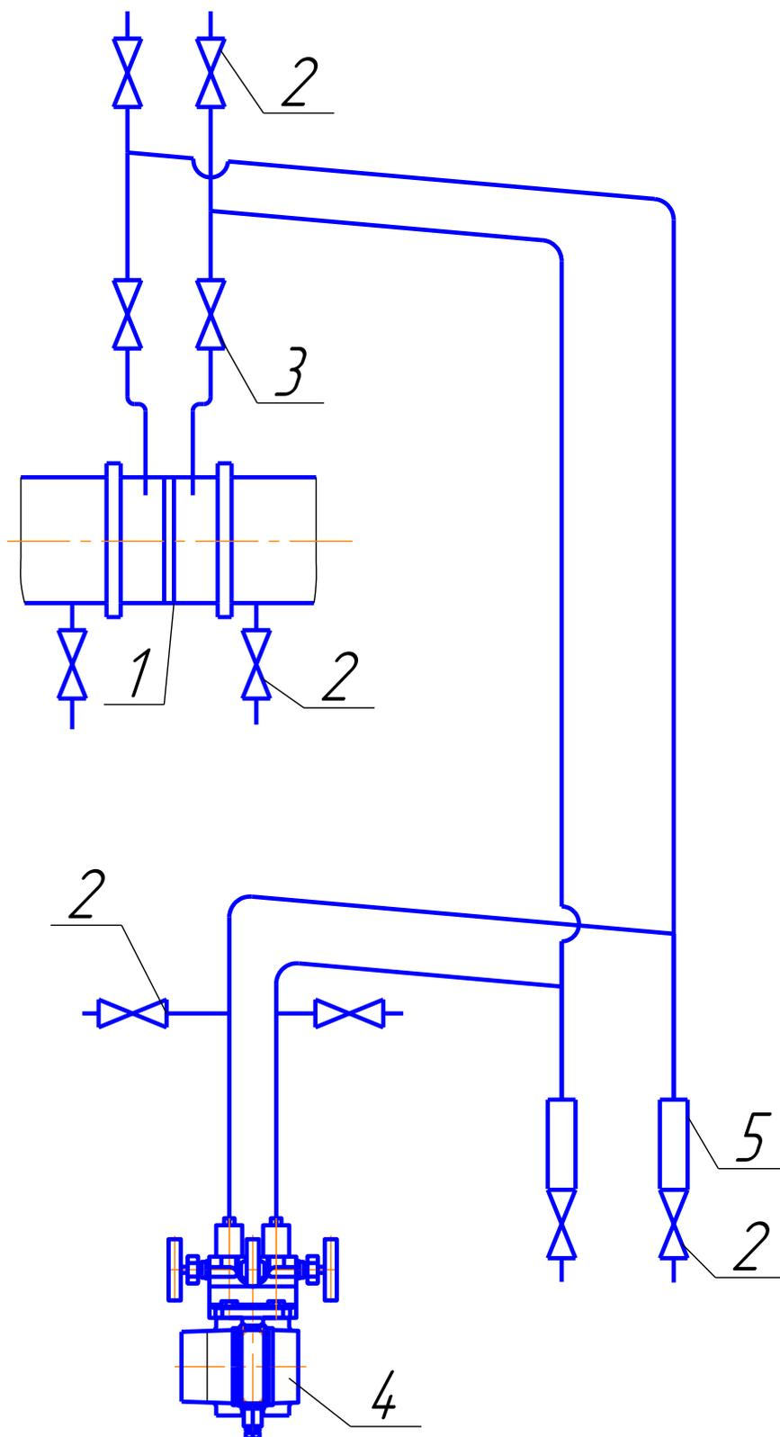
Рисунок 7-Схема соединительных линий при измерении расхода газа
