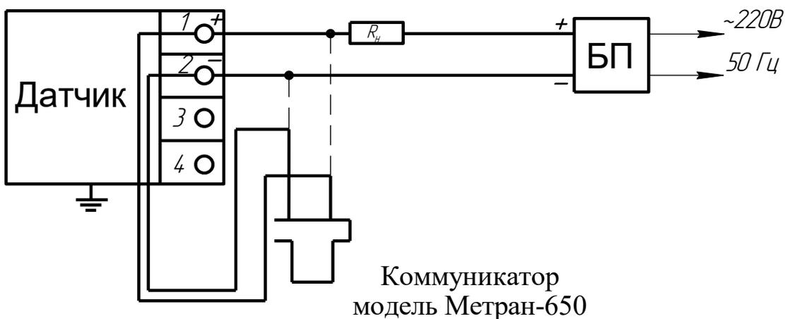
Рисунок Г.2 – Выходной сигнал 4-20 мА
