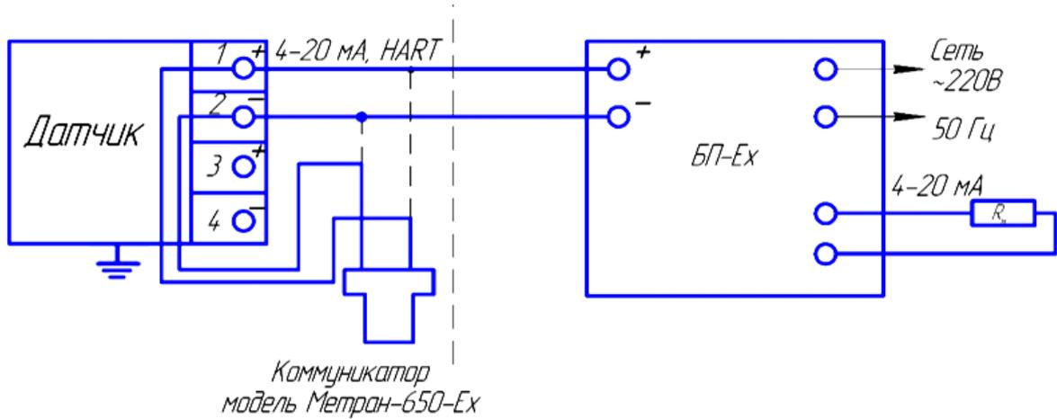
БП-Ex - искробезопасный блок питания (например БПД-40-2к-Ex)
