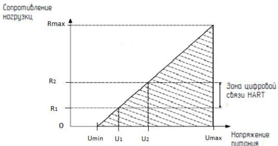
Пределы допускаемого нагрузочного сопротивления
