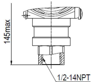
Для соединения с процессом код 2B
