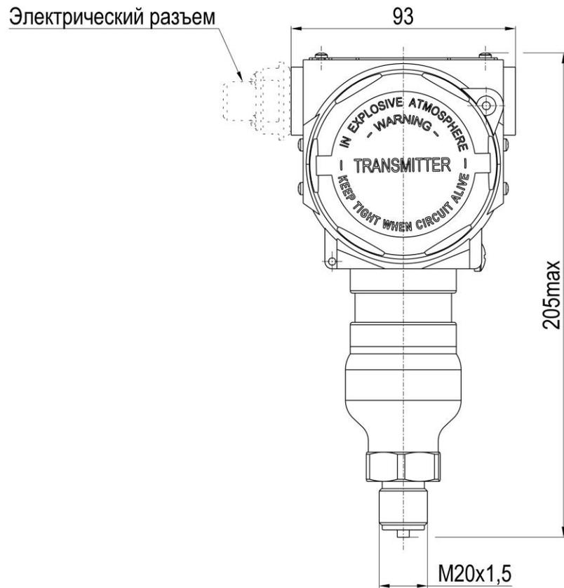
Для соединения с процессом код 2G
