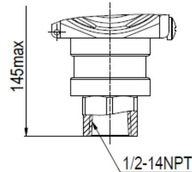
Для соединения с процессом код 2B
