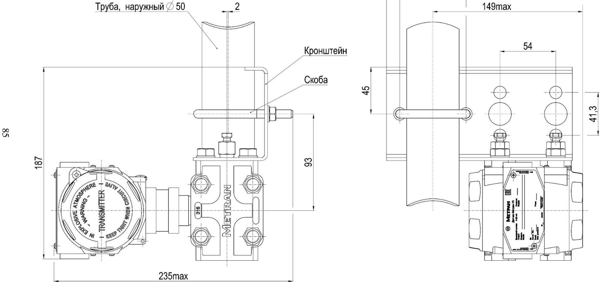
Рисунок Ж.4 – Датчики моделей 75CD/CG с кронштейном В1 или В4. Остальное смотри Рисунок Ж.1
