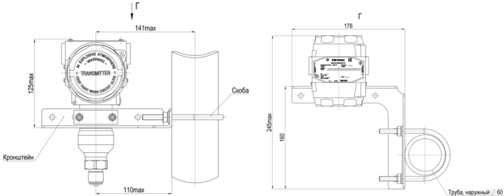
Рисунок Ж.13 – Датчики моделей 75PA/75PG с установленным монтажным кронштейном В4
