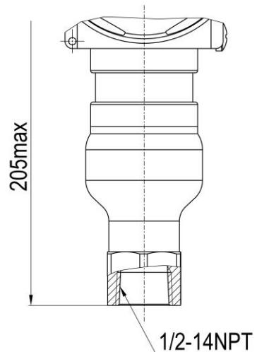
Рисунок Ж.11 – Датчики моделей 75PA/75PG с индикатором. Остальное см. Рисунок Ж.1
