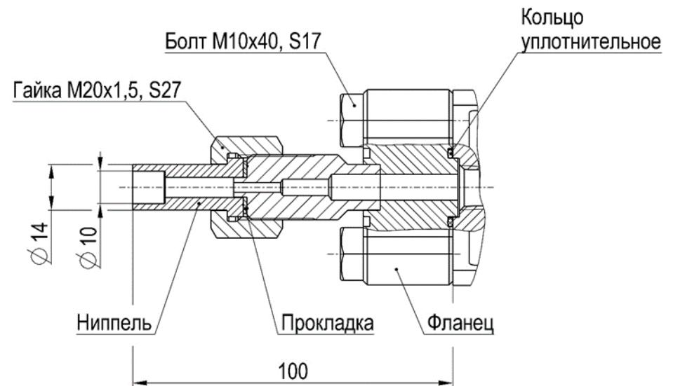
Рисунок Ж.6 – монтажные части коды D5
