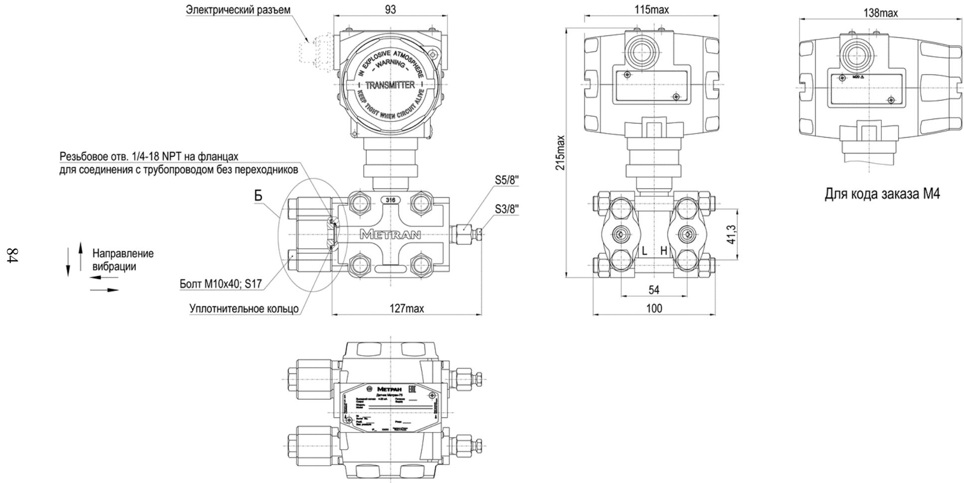
H и L – маркировка подвода давления на корпусе датчика: H соответствует большему давлению; L соответствует меньшему давлению.
