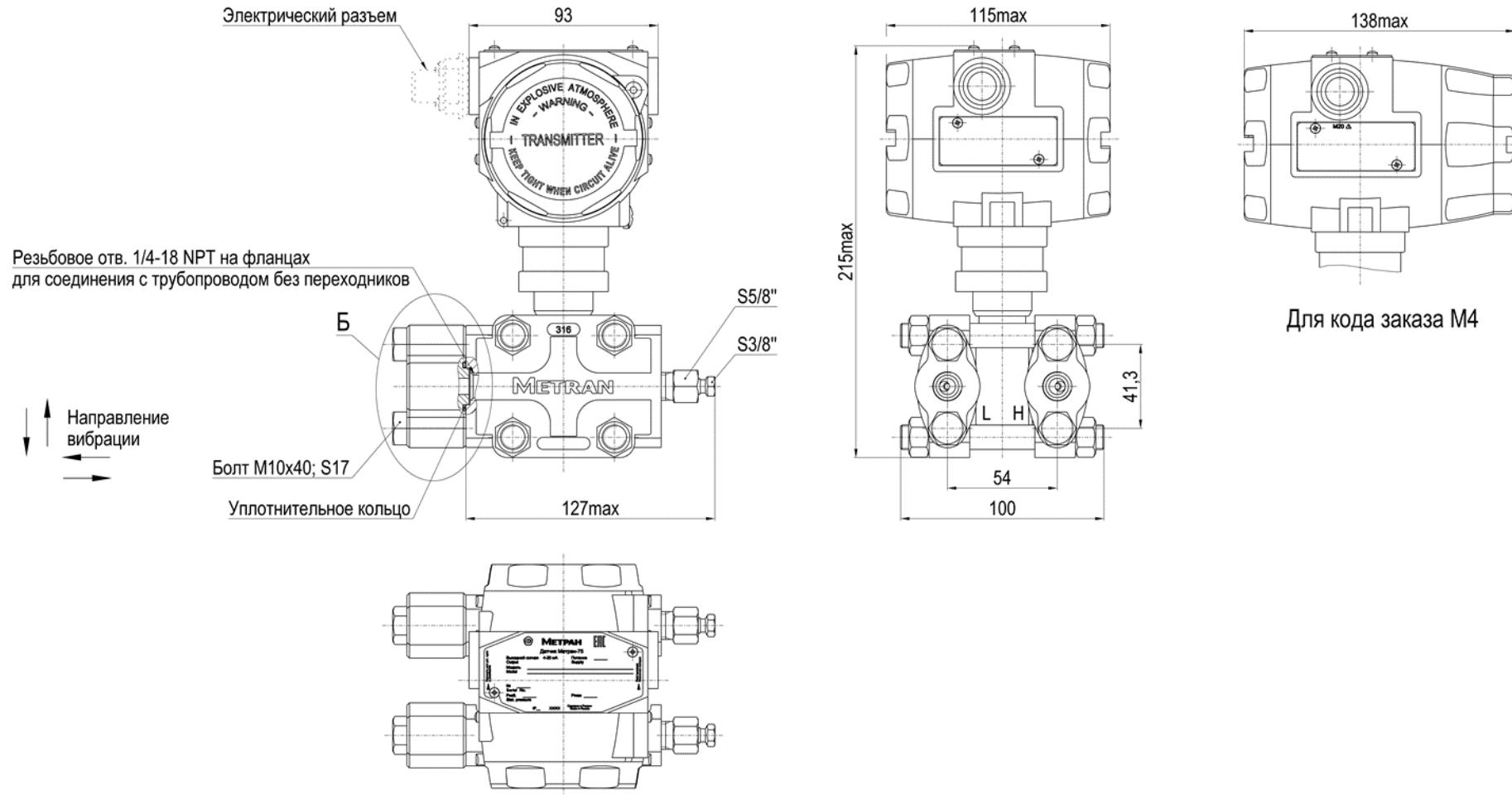
Н и L – маркировка подвода давления на корпусе датчика: Н соответствует большему давлению; L соответствует меньшему давлению.
