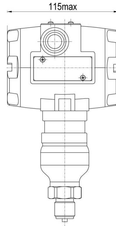
Для соединения с процессом код 2В
