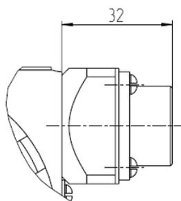
Разъём DIN 43650 (код SC5)
