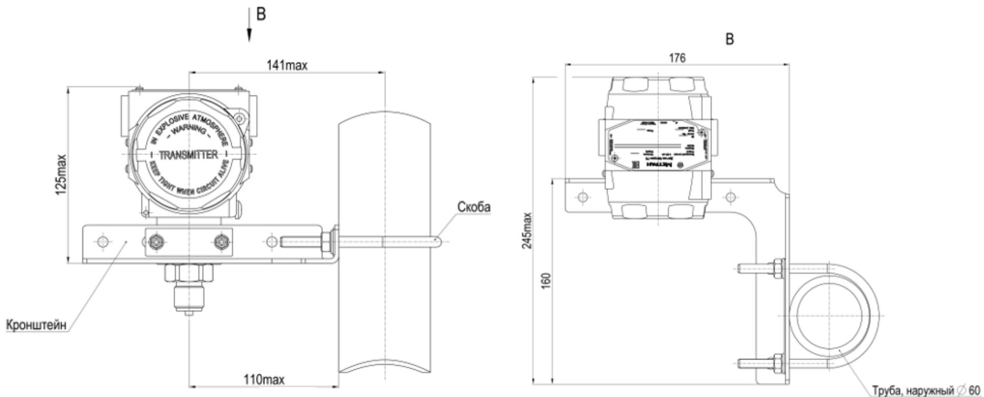
Рисунок Ж.10 – Датчики моделей 75TG/75TA с установленным монтажным кронштейном В4
