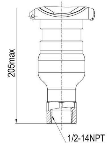
Рисунок Ж.11 – Датчики моделей 75РА/75РГ с индикатором. Остальное см. Рисунок Ж.1
