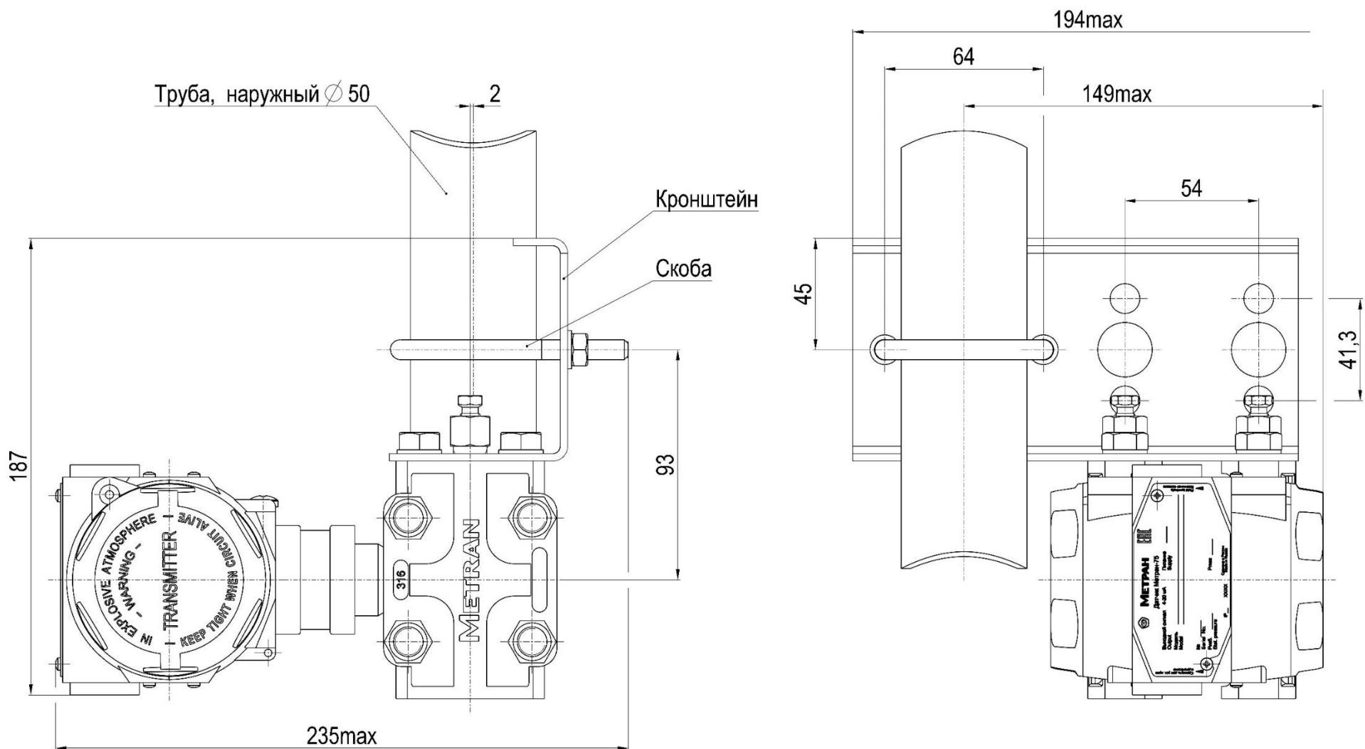
Рисунок Ж.4 – Датчики моделей 75CD/CG с кронштейном В1 или В4. Остальное смотри Рисунок Ж.1
