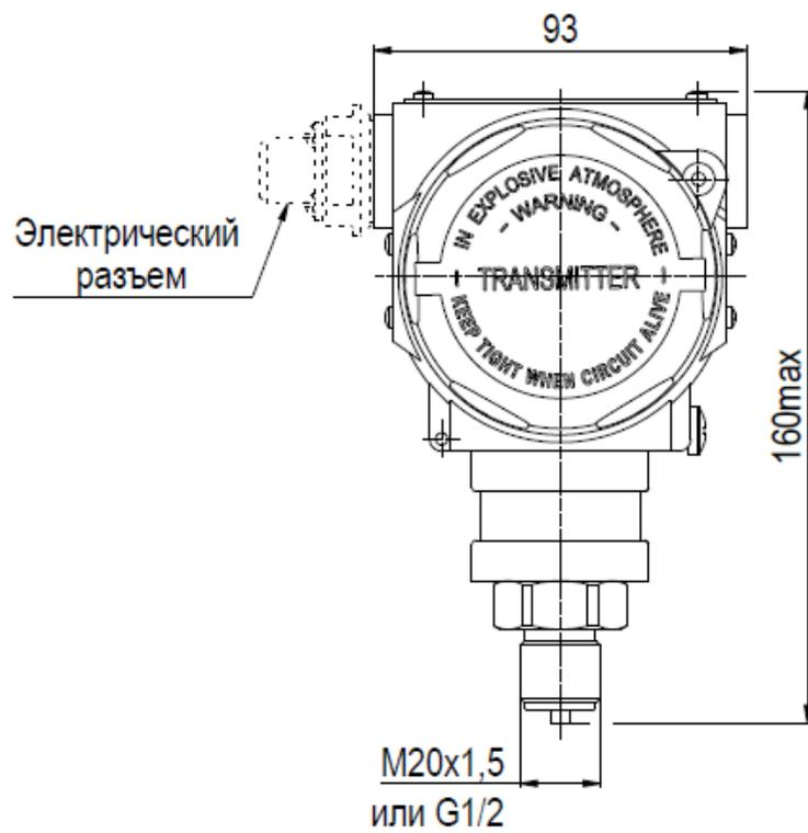
Для соединения с процессом код 2G или 2C
