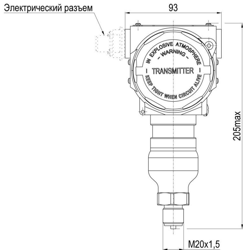
Для соединения с процессом код 2G
