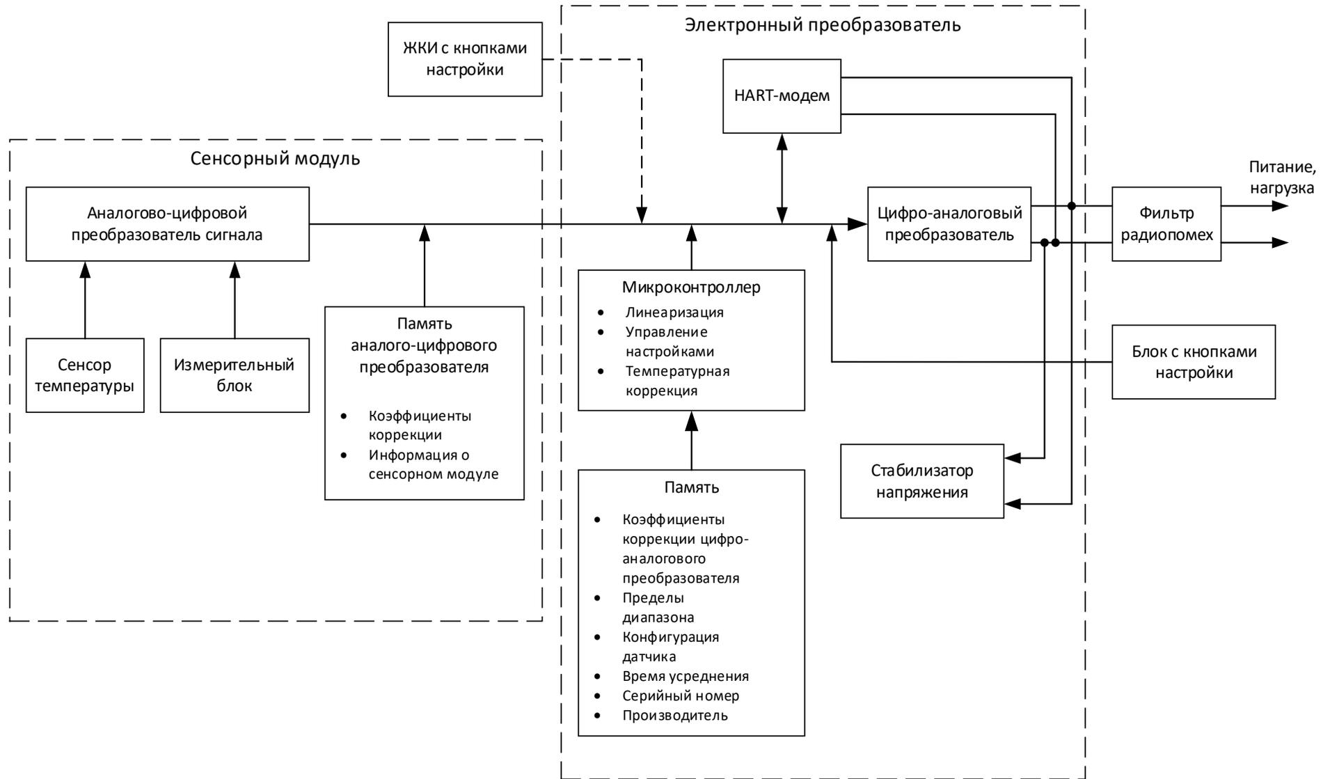
Рисунок 1 – Функциональная блок-схема
