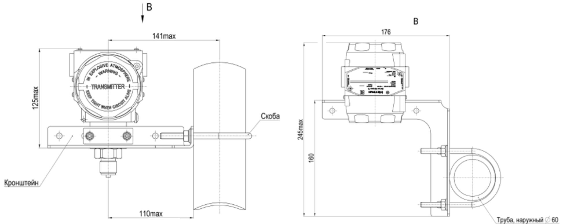
Рисунок Ж.10 – Датчики моделей 75TG/75ТА с установленным монтажным кронштейном В4
