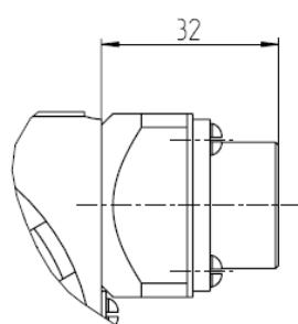
Разъём DIN 43650 (код SC5)
