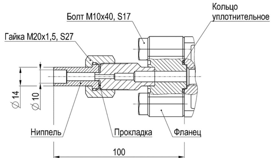
Рисунок Ж.5 – монтажные части коды D1-D4
