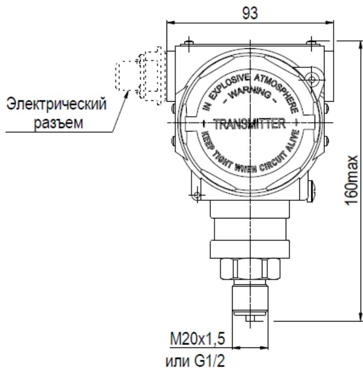
Для соединения с процессом код 2G или 2C
