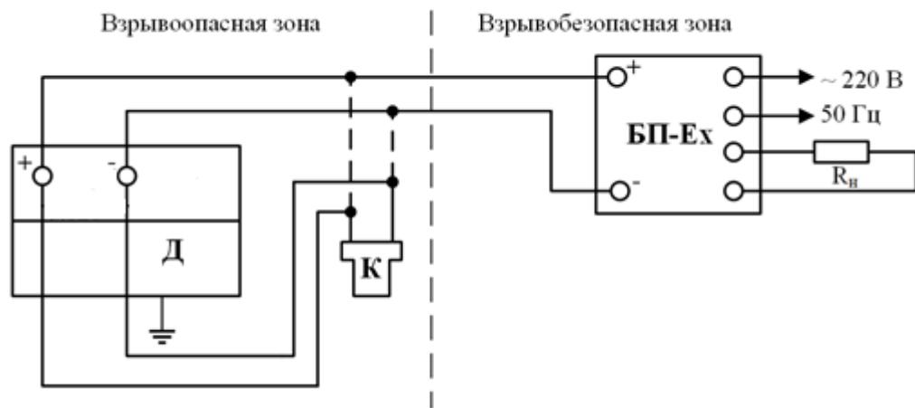
БП-Ex – искробезопасный блок питания
