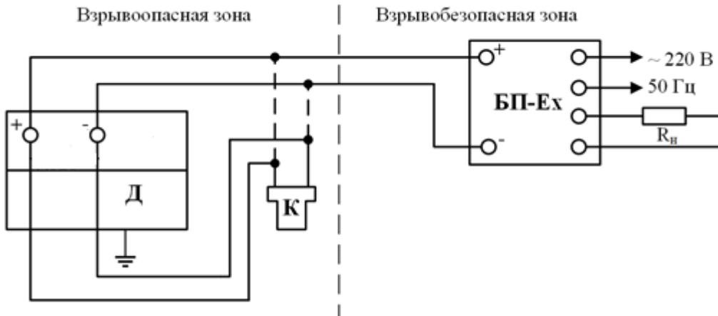
БП-Ех – искробезопасный блок питания
