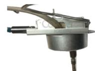
**МЭМС детектор по теплопроводности (микро-ДТП)** работает по такому же принципу, что и ДТП, но выполнен по микроэлектронной технологии и использует ячейку малого объема для повышения чувствительности при низкой скорости потока. Объем ячейки и ее геометрия оптимизированы для использования вместе с капиллярными колонками.
