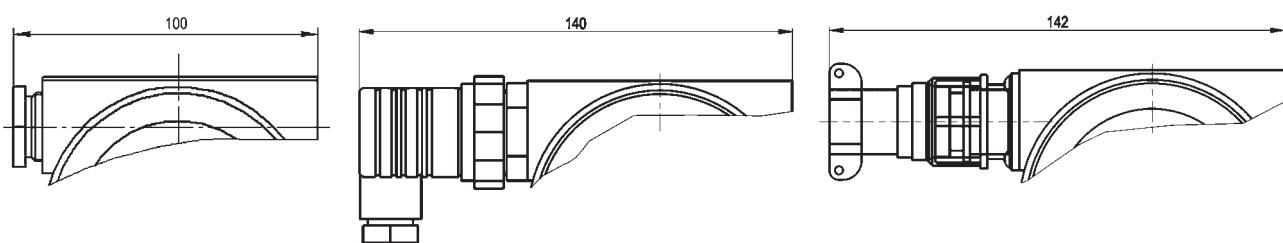
Рис.10. Подключение через сальниковый ввод (код "С"), через штепсельный разъем с установленной розеткой типа 2РМГ22КПН10Г1В1 (код "ШР") и через разъем DIN 43650a (код "Д")
