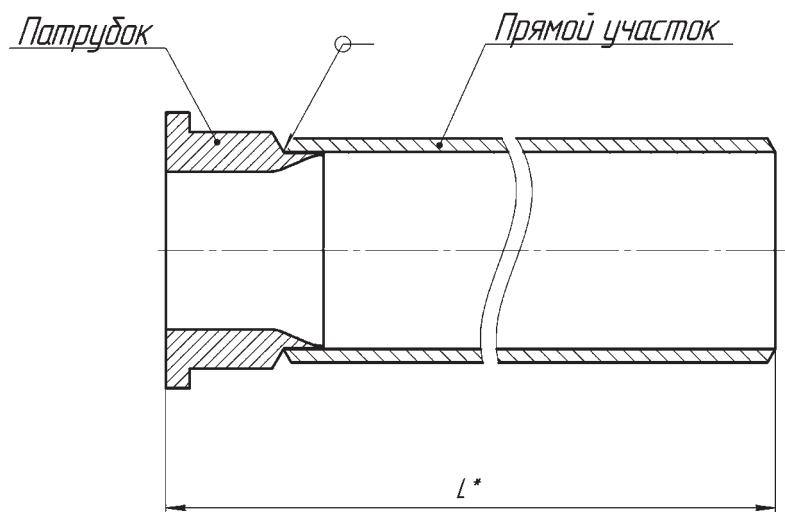
Рис.12. Для  $D_u$  150, 200 мм прямой участок приваривается к патрубку, накидной фланец устанавливается на патрубок (фланец условно не показан)
