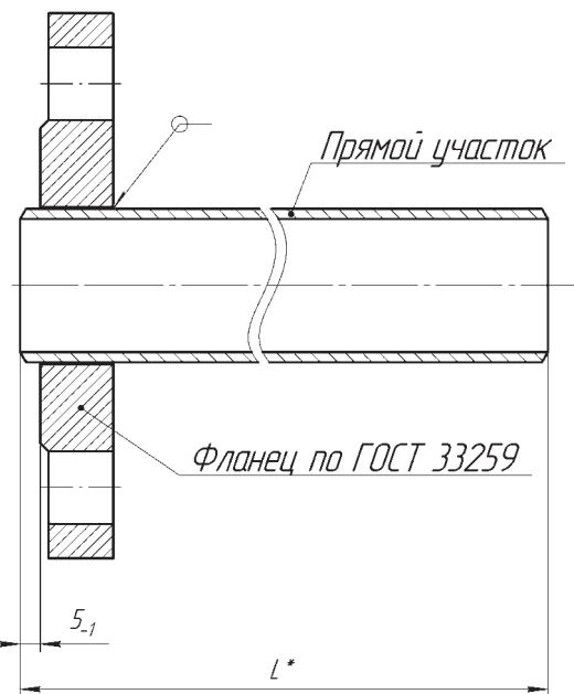
Рис.11. Установка фланца на прямой участок для  $D_u$  25 - 100 мм
