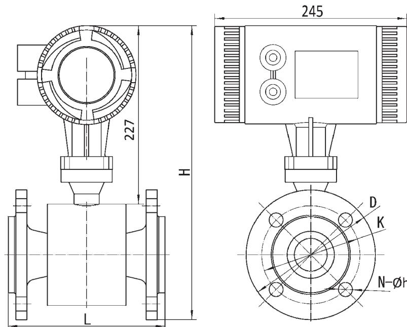
Рис. 18. Расходомер модели Метран-370MR с преобразователем интегрального монтажа.
