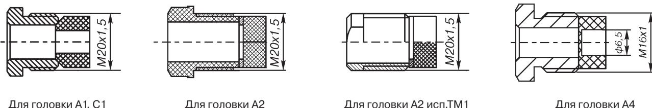
Рис.6. Сальниковый ввод (С)<sup>1)</sup>.
