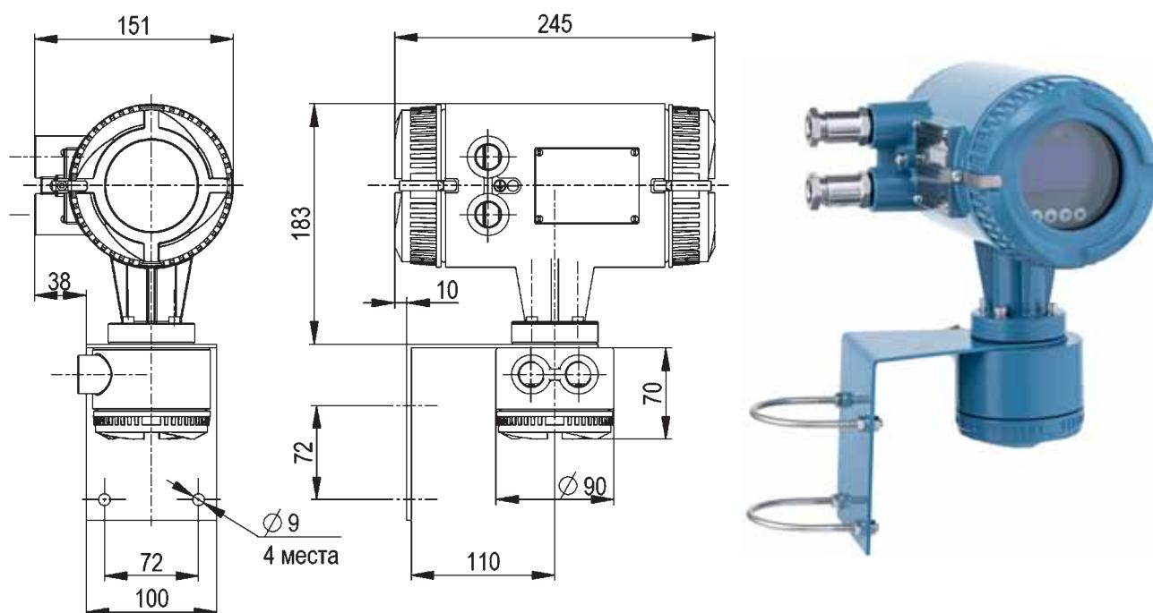
Рис. 24. Удаленный преобразователь полевого исполнения (на кронштейне).
