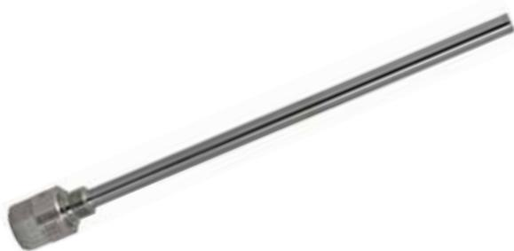
Резьбовые защитные гильзы соединяются с технологическим трубопроводом (резервуаром) посредством резьбы. Этот способ обеспечивает простоту их установки и демонтажа. Несмотря на то, что данный способ монтажа наиболее распространен, он также характеризуется самым низким рабочим давлением из всех способов установки.
