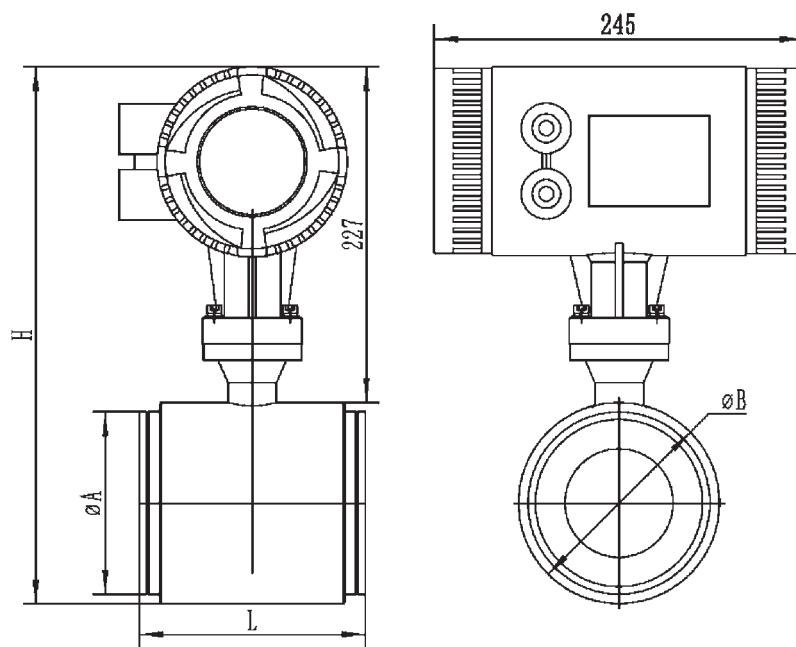
Рис. 20. Расходомер модели Метран-370MW с преобразователем интегрального монтажа.
