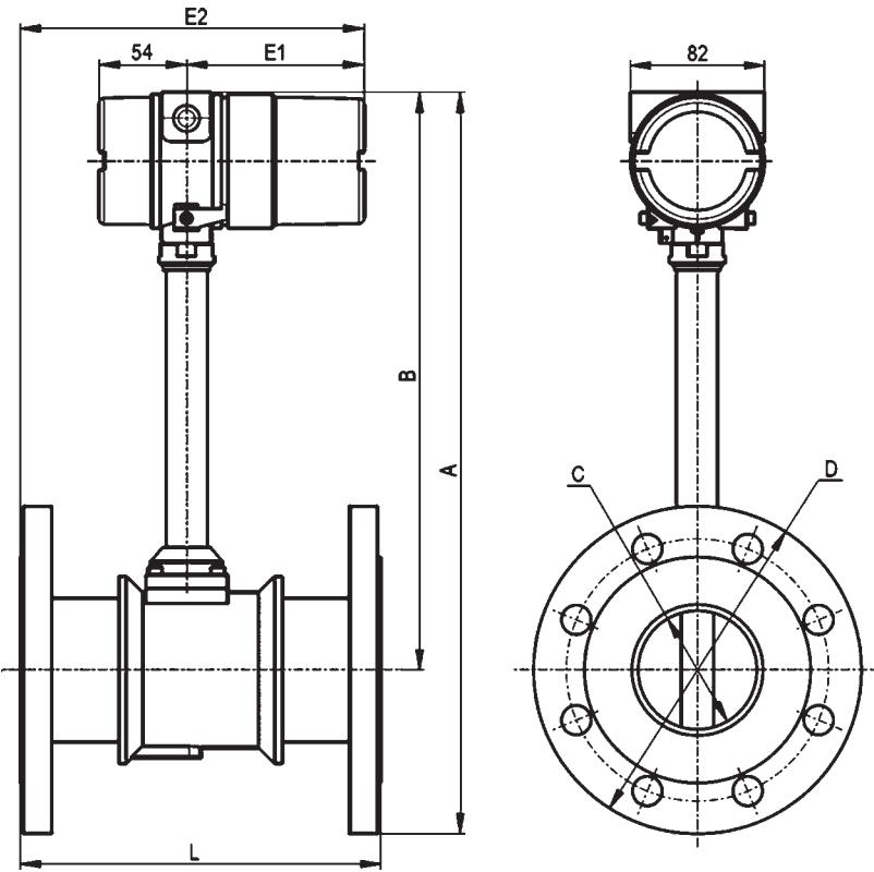
Рис. 9. Габаритные размеры расходомера фланцевого исполнения интегрального монтажа
