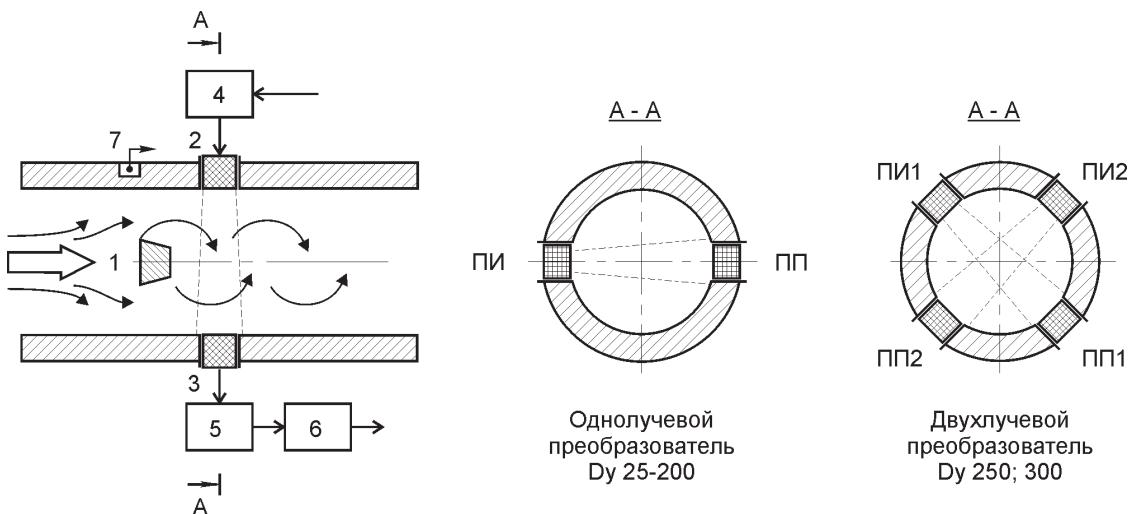
Расходомер представляет собой моноблочную конструкцию, состоящую из проточной части и электронного блока. В корпусе проточной части расположены: тело обтекания ТО - призма трапециoidalного сечения (1), пьезоизлучатели ПИ (2), пьезоприемники ПП (3) и термодатчик (7).
