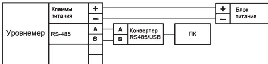
Рис. 10. Схема соединений уровнемера с кодом типа выходного сигнала М.
