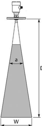
Угол рассеивания луча ( $\alpha$ ) для типов антенн:
