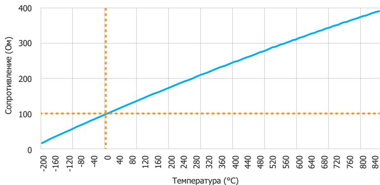
**Рис. 1. Изменение сопротивления относительно температуры для платиновых ТС (PT100).**
