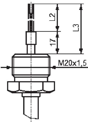
Исполнение ТП без соединительной головки
