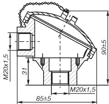
Соединительная головка A1<sup>1)</sup>
