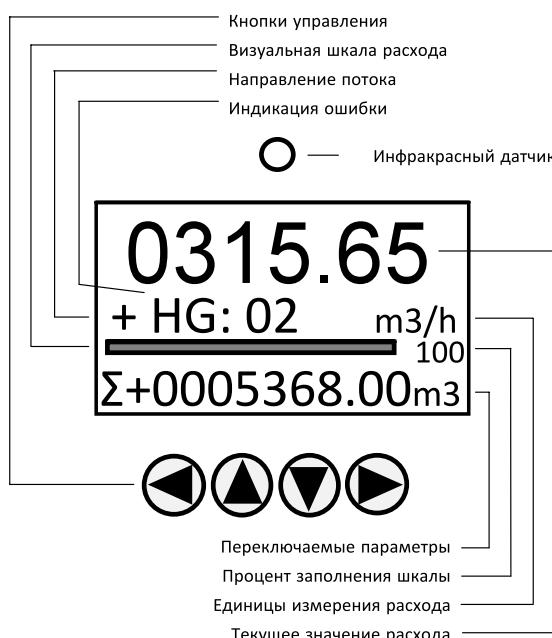
Рис. 10. ЛОИ преобразователя полевого монтажа.
