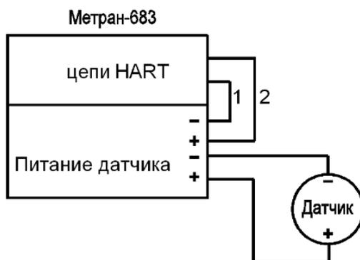
Схема подключения с использованием встроенного источника питания. Для использования данного варианта необходимо подключить перемычки 1 и 2
