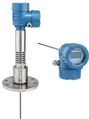
**Метран-730\*** – волноводный радарный уровнемер для измерения уровня жидкостей и сыпучих материалов по технологии TDR(рефлектометрия с временным разрешением). Уровнемеры предназначены для работы во взрывобезопасных и взрывоопасных условиях. Возможность настройки как по месту при помощи LOI, так и удаленно по цифровым протоколам (HART, Modbus, Profibus). Предназначен для работы при низких температурах окружающего воздуха и широком диапазоне рабочих температур и давлений.
