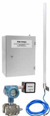
Адаптеры LoRaWAN устанавливаются в комплекте с датчиками давления, температуры, уровня и расхода и представляют из себя полностью законченное, автономное и беспроводное решение, позволяющее обеспечивать работу датчика без внешнего электропитания и передавать данные по беспроводной сети стандарта LoRaWAN. Модуль сбора данных обеспечивает организацию работы беспроводной сети LoRaWAN и преобразует полученные данные в стандартные промышленные протоколы Modbus и OPC.
