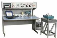
Готовые решения для создания новых и переоснащения действующих метрологических лабораторий с использованием эталонов производства ПГ “Метран”, а также ведущих российских и зарубежных компаний. Готовые рабочие места инженера метролога и специалиста по КИПиА для обслуживания широкого спектра средств измерений.
