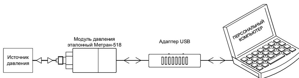
Рис. 1. Схема подключения модуля давления Метран-518 к компьютеру.
