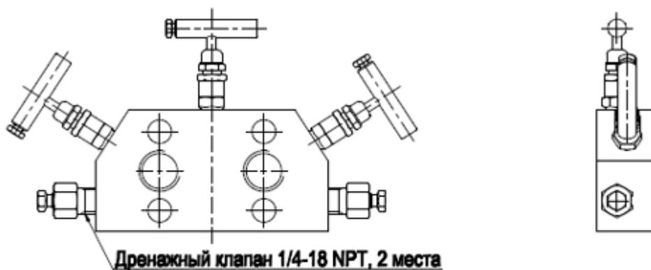
Рисунок Б.3.4 – Трехвентильный блок модели 0105 М С 3 с кодом соединения с процессом В, D и кодом специального исполнения Н1. Остальное – см. рисунок Б.2.4
