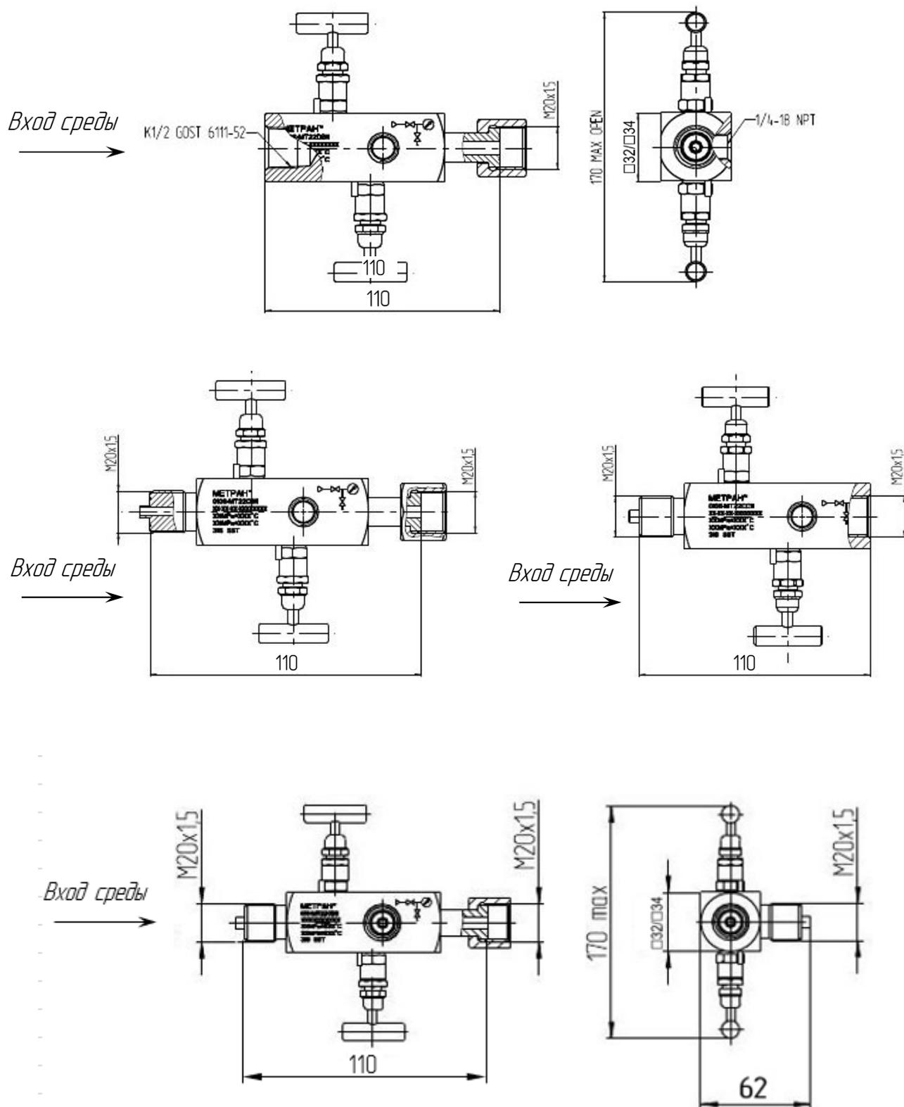
Рисунок Б.4.1 – Двухвентильный блок модели 0106 М Т 2
