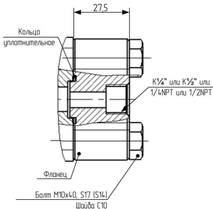
Рисунок Г.2 – Монтажные части (коды D1-D4)
