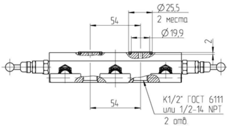
КБ с кодом соединения с процессом С
