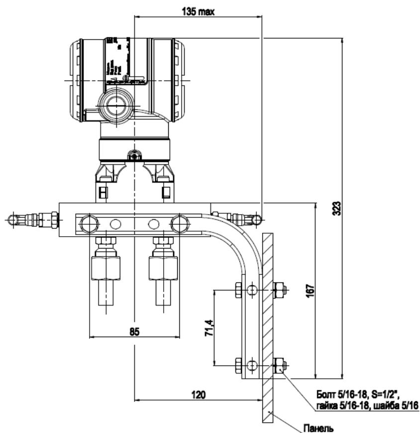
Рисунок В.9 – Монтаж клапанного блока 0105 М С 5 с установленным кронштейном (код В4) на панели для датчиков типа Метран-150СДР.
