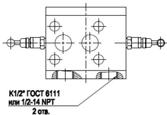
Рисунок Б.2.9 – Трехвентильный блок модели 0105 М Т 3 с кодом соединения с процессом В или D. Остальное – см. рисунок Б.2.8
