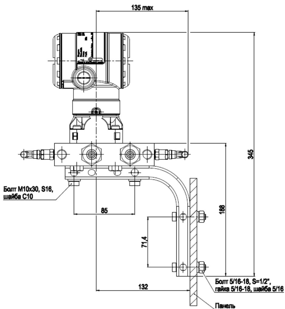
Рисунок В.11 – Монтаж клапанного блока 0105 М S 5 с установленным кронштейном (код В4) на панели для датчиков типа Метран-150CDR.
