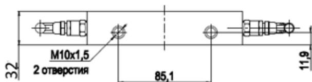
Рисунок Б.1.4 – Пятивентильный блок модели 0105 М С 5 с кодом соединения с процессом В или D
