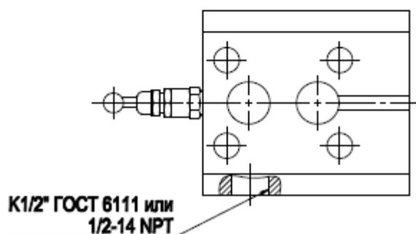
Рисунок Б.4.8 – Двухвентильный блок модели 0105 М Т 2 с кодом соединения с процессом В, D (для датчиков типа Метран-150CGR).
