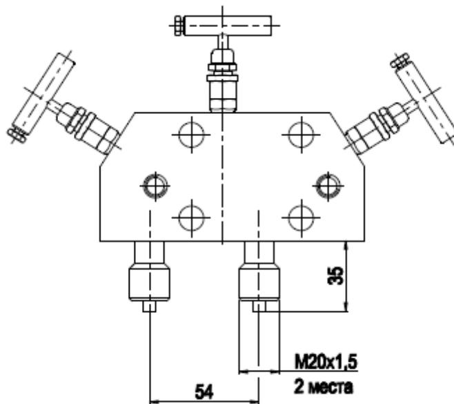
Рисунок Б.2.7 – Трехвентильный блок модели 0105 М S 3 с кодом соединения с процессом С. Остальное – см. рисунки Б.2.6
