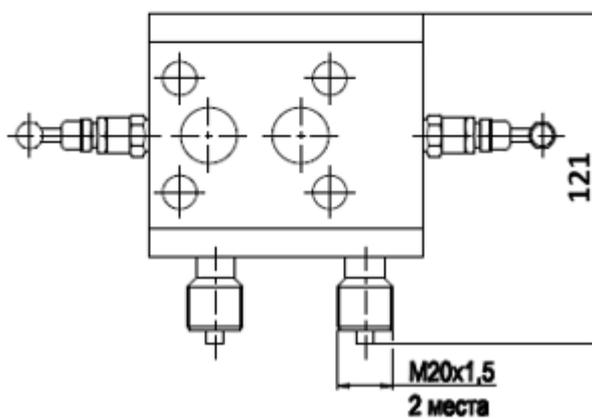
Рисунок Б.2.10 – Трехвентильный блок модели 0105 М Т 3 с кодом соединения с процессом С. Остальное – см. рисунок Б.2.8
