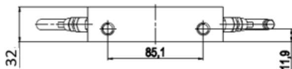
Рисунок Б.2.4 – Трехвентильный блок модели 0105 М С 3 с кодом соединения с процессом В или D
