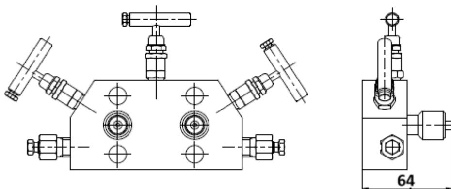
Рисунок Б.3.5 – Трехвентильный блок модели 0105 М С 3 с кодом соединения с процессом С и кодом специального исполнения Н1. Остальное – см. рисунок Б.2.5
