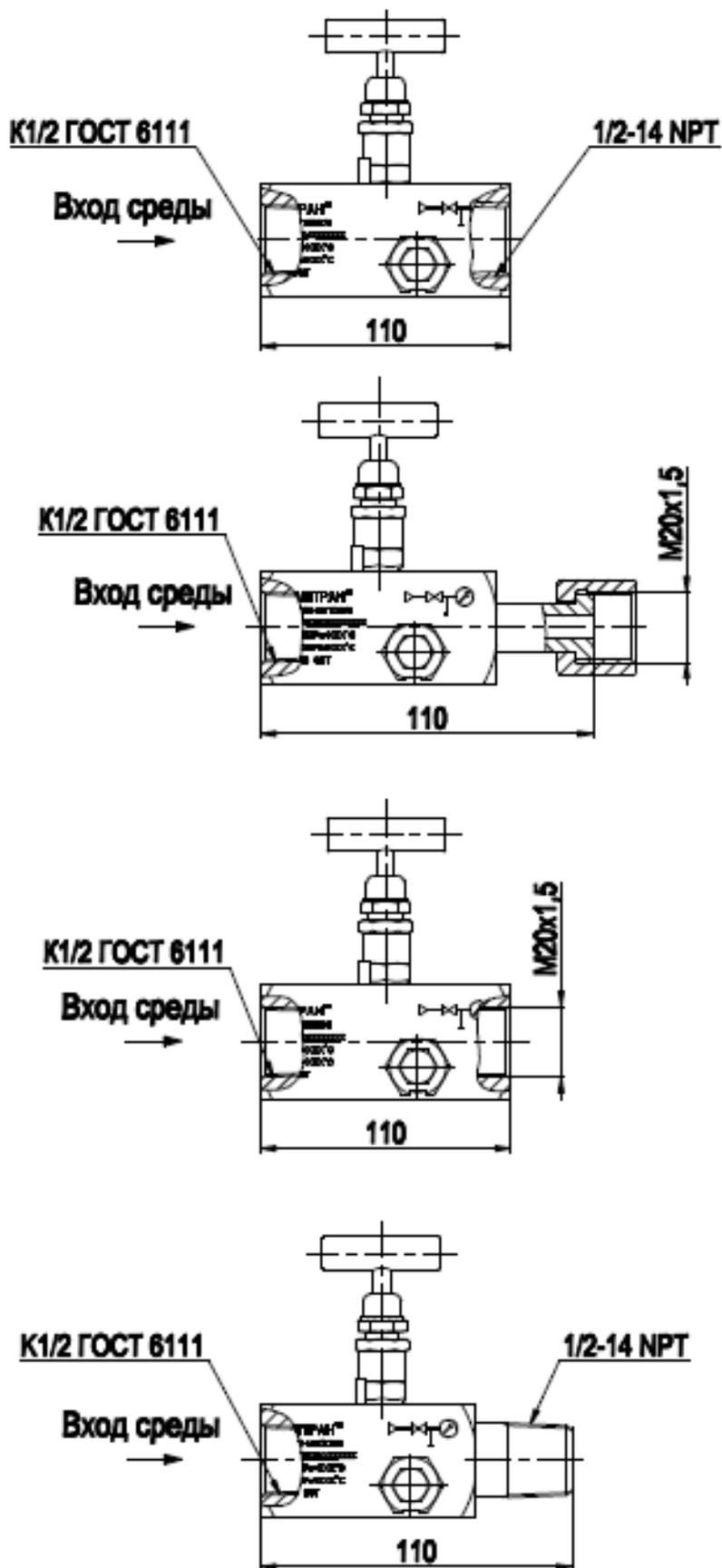
Рисунок Б.5.16 – Одновентильный блок модели 0106 М Т 1
