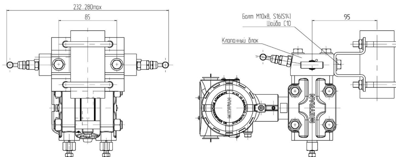
Рисунок В.2 – Монтаж клапанного блока 0104 М W с установленными кронштейнами (код VC, VS) на трубе для датчиков типа Метран-150CD. Остальное см. рисунок В.1
