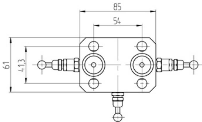
КБ с кодом соединения с процессом С
