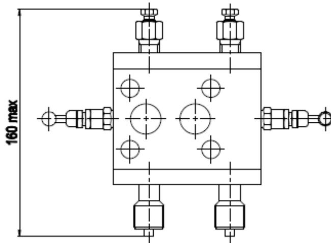
Рисунок Б.3.10 – Трехвентильный блок модели 0105 М Т 3 с кодом соединения с процессом С и кодом специального исполнения Н1
