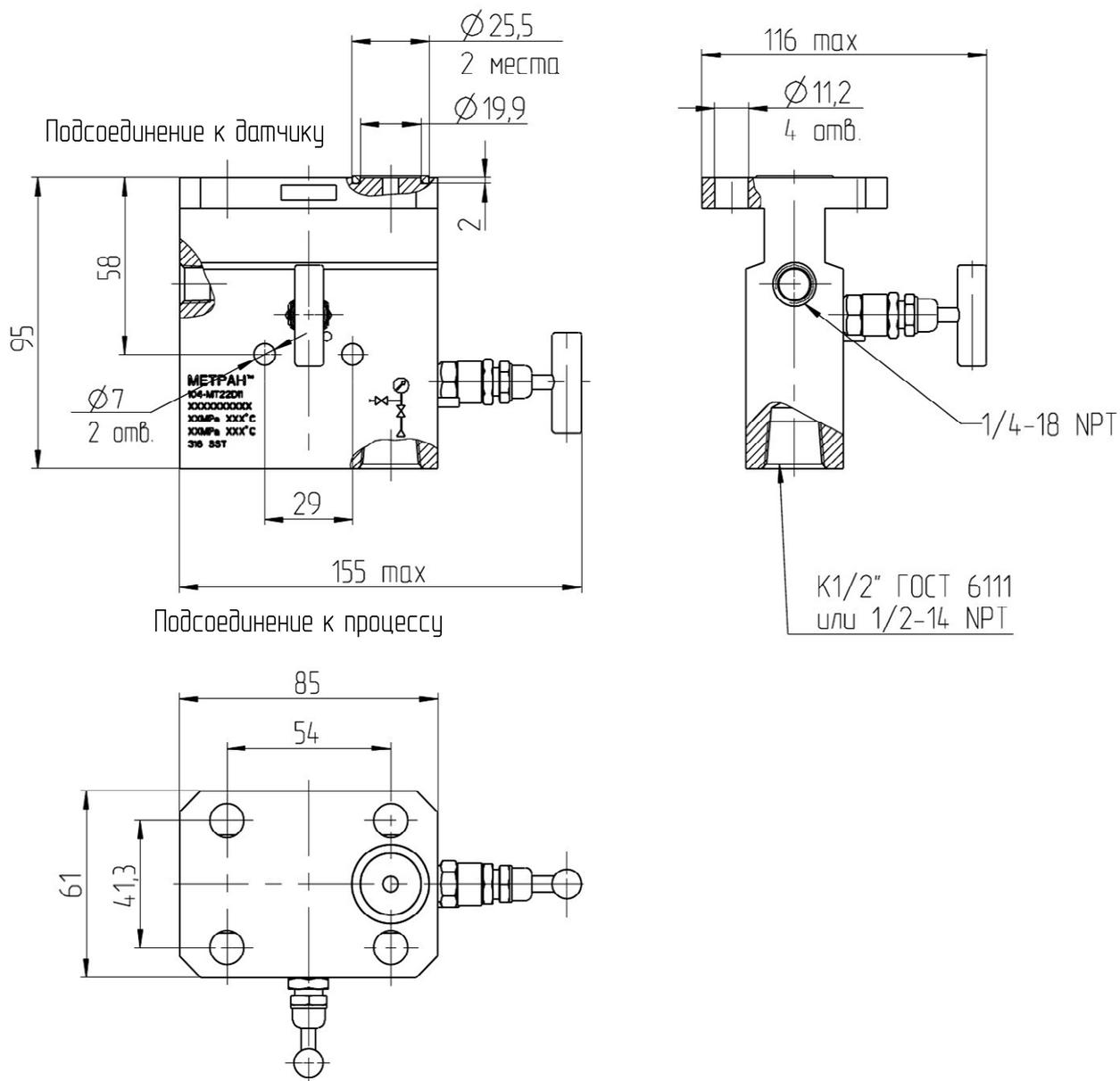
Рисунок Б.4.2 – Двухвентильный блок модели 0104 М Т 2 с кодом соединения с процессом В или D (для датчиков с традиционным фланцевым соединением типа Метран-150CG)
