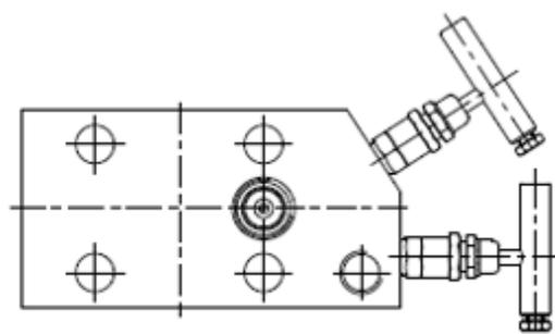
Рисунок Б.4.4 – Двухвентильный блок модели 0105 М С 2 с кодом соединения с процессом С (для датчиков типа Метран-150CGR).
