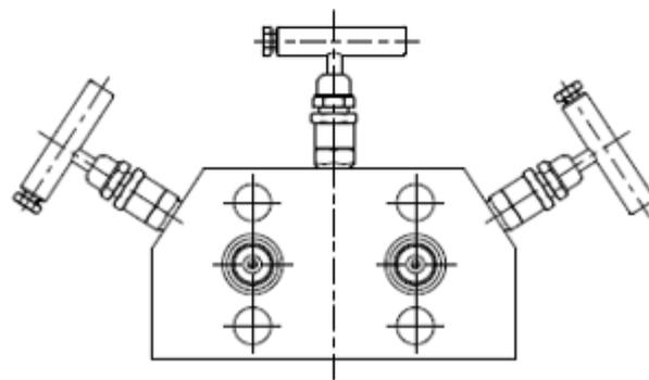
Рисунок Б.2.5 – Трехвентильный блок модели 0105 М С 3 с кодом соединения с процессом С. Остальное – см. рисунки Б.2.4
