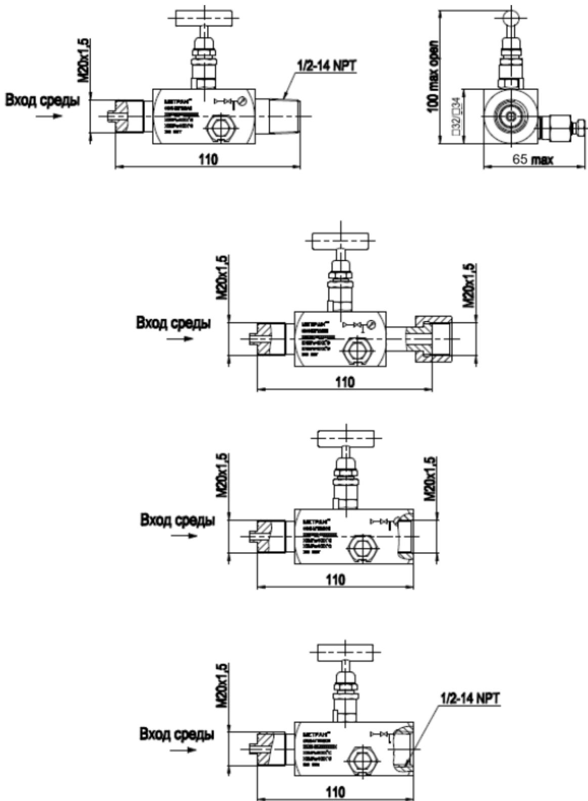
Рисунок Б.5.1а – Одновентильный блок модели 0106 М Т 1
