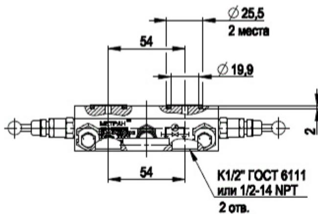
КБ с кодом соединения с процессом С
