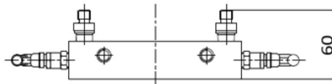
Рисунок Б.1.5 – Пятивентильный блок модели 0105 М С 5 с кодом соединения с процессом В, D и кодом специального исполнения Н2. Остальное – см. рисунок Б.1.4
