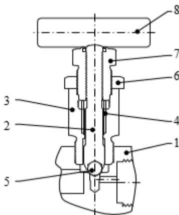
1 – корпус КБ; 2 – шток вентиля; 3 – корпус вентиля; 4 – сальниковое уплотнение;
