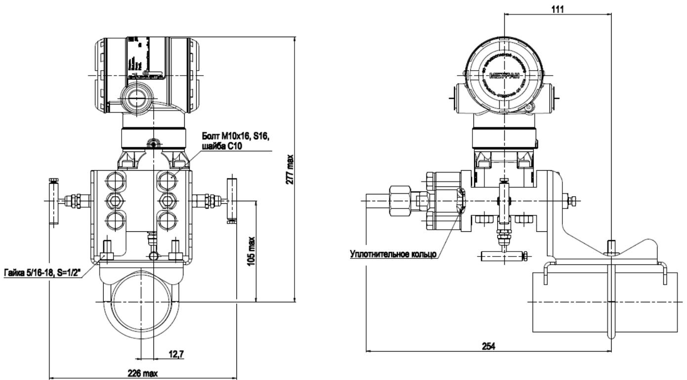
Рисунок В.7 – Монтаж клапанного блока 0105 М Т 3 и 0105 М Т 2 с установленными монтажными фланцами (D1-D6) и кронштейнами (код В1) на трубе для датчиков типа Метран-150CDR.
