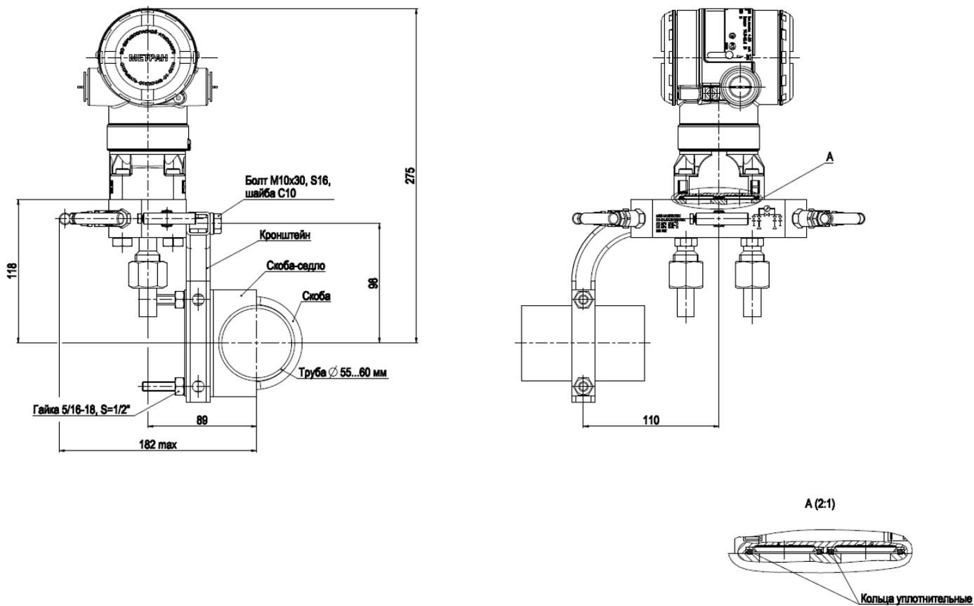
Рисунок В.8 – Монтаж клапанного блока 0105 М С 5 с установленным кронштейном (код В4) на трубе для датчиков типа Метран-150CDR
