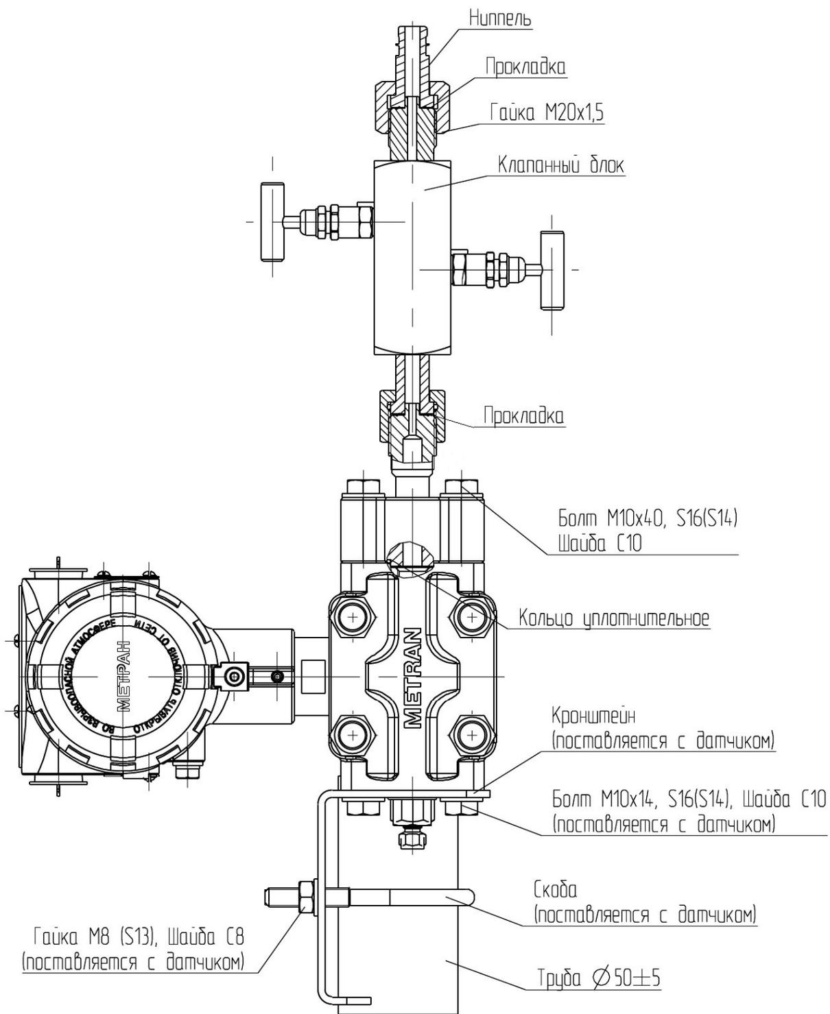
Рисунок В.4 – Вариант установки клапанного блока 0106 М Т для датчиков типа Метран-150СГ.
