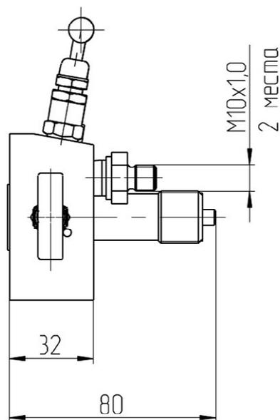
Продолжение рисунка Б.1.3 – Пятивентильный блок модели 0104 M W 5 с кодом соединения с процессом В, D или С
