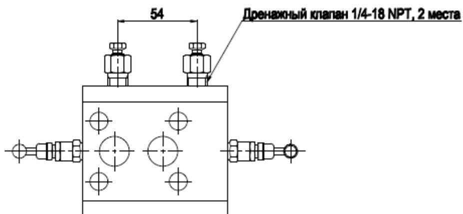
Рисунок Б.3.9 – Трехвентильный блок модели 0105 М Т 3 с кодом соединения с процессом В, D и кодом специального исполнения Н1
