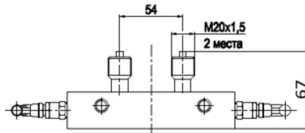
Рисунок Б.1.6 – Пятивентильный блок модели 0105 М С 5 с кодом соединения с процессом С. Остальное – см. рисунок Б.1.4
