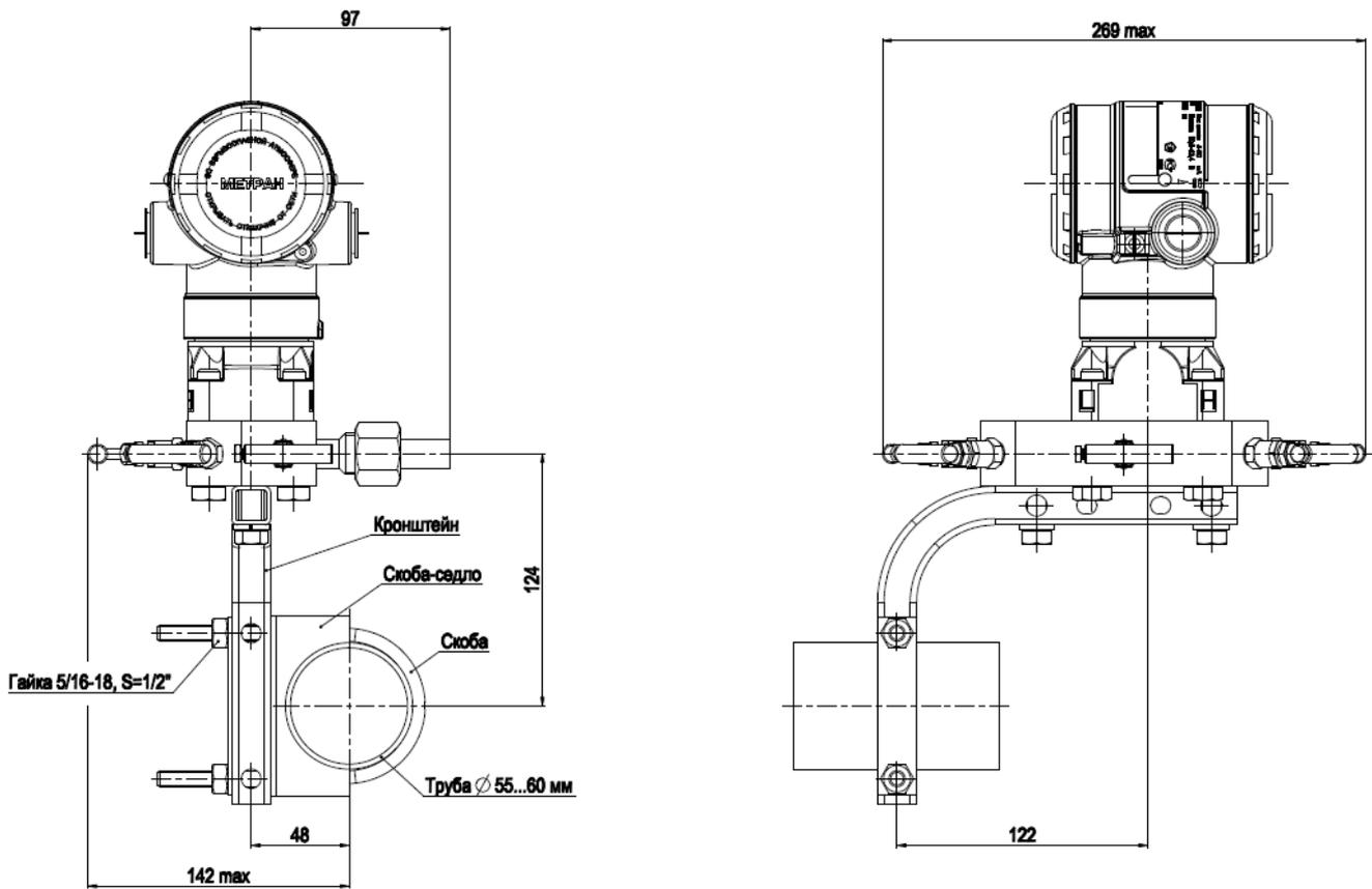
Рисунок В.10 – Монтаж клапанного блока 0105 М S 5 с установленным монтажным кронштейном (код В4) на трубе для датчиков типа Метран-150CDR
