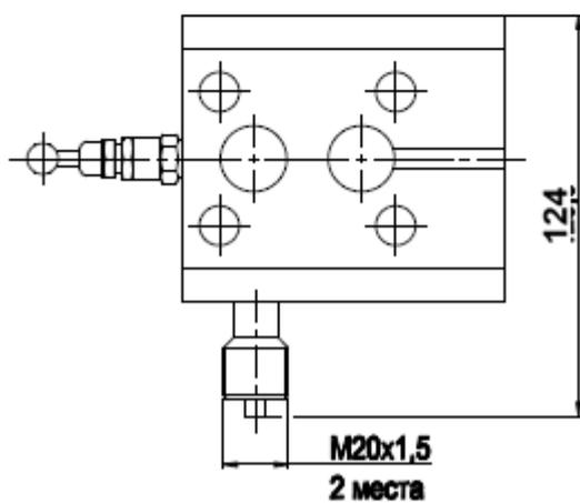
Рисунок Б.4.9 – Двухвентильный блок модели 0105 М Т 2 с кодом соединения с процессом С (для датчиков типа Метран-150CGR).
