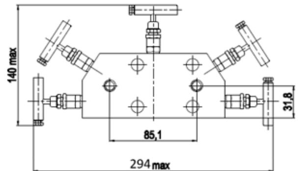
Рисунок Б.1.8 – Пятивентильный блок модели 0105 М S 5 с кодом соединения с процессом В или D
