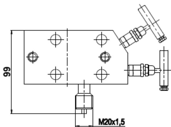
Рисунок Б.4.6 – Двухвентильный блок модели 0105 М S 2 с кодом соединения с процессом С (для датчиков типа Метран-150CGR).
