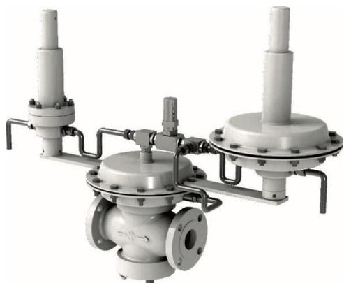
Регулятор с двойным пилотным управлением серии ВЗ используется для точного регулирования давления в системах защиты резервуаров с очень низким давлением. Он поддерживает давление инертного газа для сохранения защитной подушки над любой жидкостью, хранящейся в резервуаре или емкости, в случаях, когда жидкость откачивается или когда емкость быстро охлаждается, что приводит к сжатию паров внутри резервуара.
