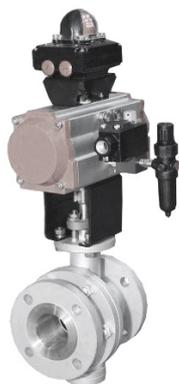
Поворотный регулирующий клапан сочетает в себе опыт и новейшие технологии, что обеспечивает превосходные динамические характеристики и низкие эксплуатационные расходы. Шаровой сегмент с V-образным вырезом имеет равнопроцентную пропускную характеристику, что обеспечивает широкий диапазон регулирования. Клапан модели UNICON 5000 устойчив к механическим включениям в рабочей среде, используется на чистых и загрязненных средах.
