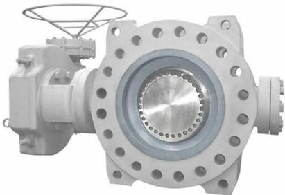
Дисковые затворы с тройным эксцентриситетом подходят для сложных технологических процессов, таких как экстремальные температурные условия, пар, химическая агрессивность рабочей среды и высокая цикличность работы. Металлическое уплотнение обеспечивает нулевую протечку в одну или в обе стороны. Прекрасно подходят для перекрытия и регулирования потока.
