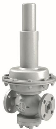
Регуляторы давления прямого действия серий DMB, DMBL, DMBH лучше всего подходят для обеспечения постоянного давления предварительно отфильтрованных не агрессивных газов и жидкостей, используемых в промышленности, коммерции и на технологических установках. Разгруженная по давлению конструкция затвора с внутренним датчиком обеспечивает превосходный контроль давления на выходе даже при очень больших колебаниях давления на входе.
