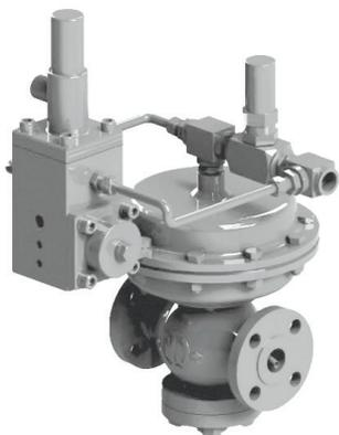
Регулятор давления серии DP3100 предназначен для точного поддержания выходного давления. Двухступенчатый пилот обеспечивает контроль выходного давления с широким диапазоном регулирования. Основной регулятор имеет сбалансированную конструкцию затвора с внешним датчиком и обеспечивает превосходный контроль давления на выходе даже при очень больших колебаниях давления на входе. Применяется на чистых газовых средах.
